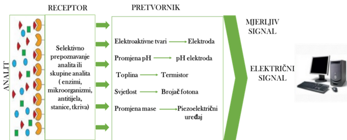
Slika 1. Shematski prikaz senzora.
