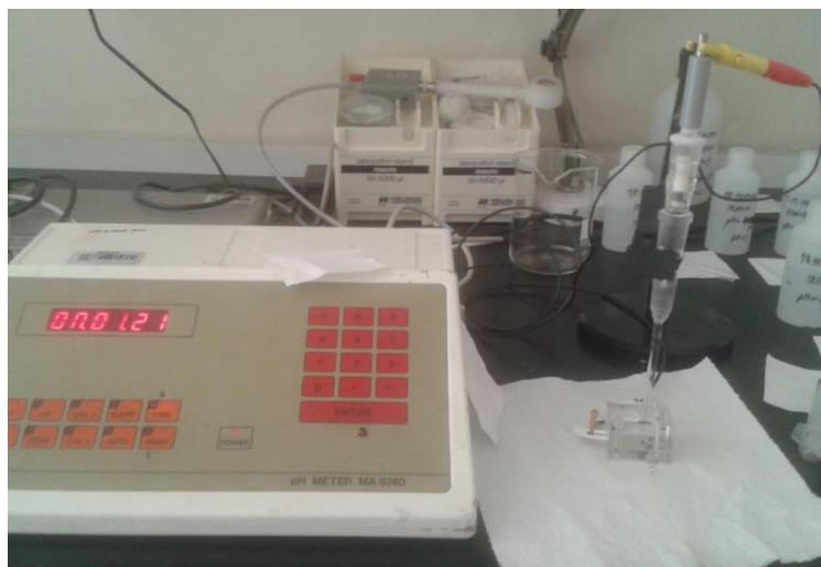
**Slika 14.** Prikaz nepprotočnog mjerjenja.
