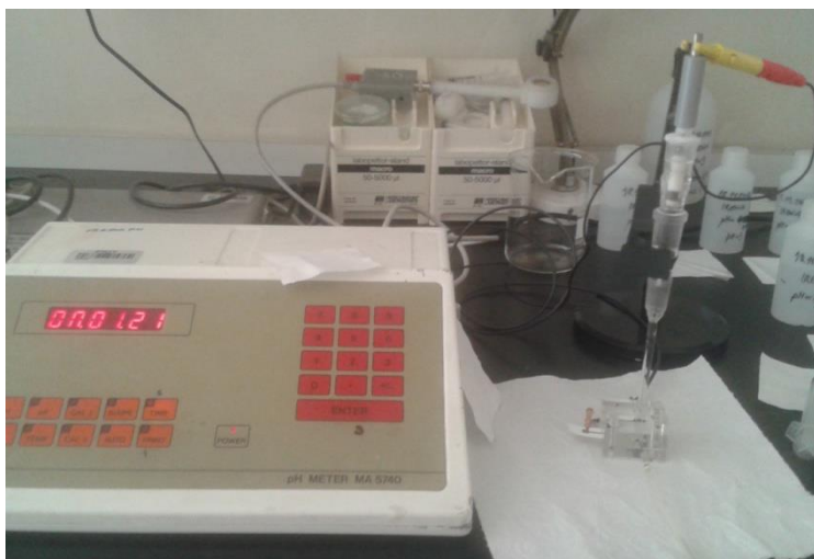
Slika 14. Prikaz neprotočnog mjerenja.
