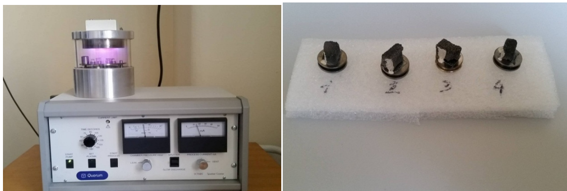
Slika 12 a) Uređaj za neparivanje b) Uzorci napareni vodljivim slojem zlata
