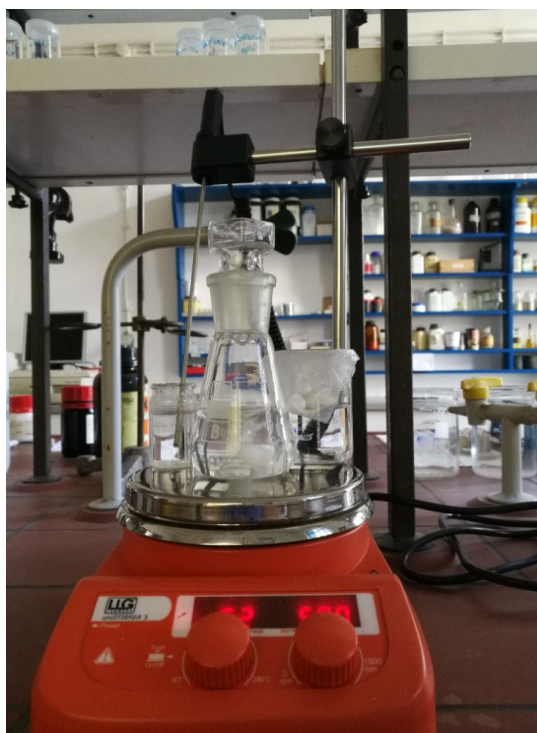
Slika 11 Prikaz zagrijavanja i miješanja otopine kopolimera BH40/PCL na magnetskoj mješalici
