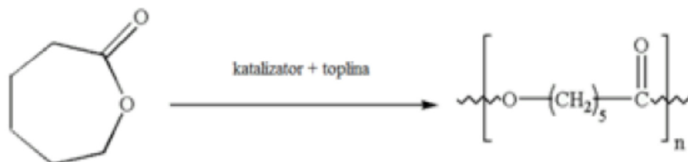
Slika 3 Sinteza poli( \epsilon -kaprolaktona) polimerizacijom otvaranja prstena (engl. ring-opening polymerization , ROP)[20]
