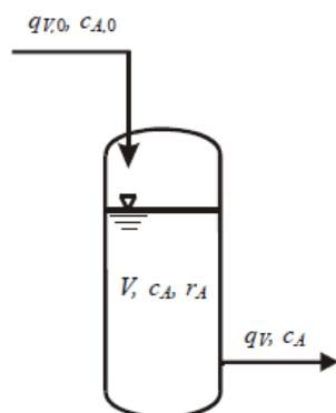
**Slika 2.2.** Shematski prikaz protočno kotlastog bioreaktora.
