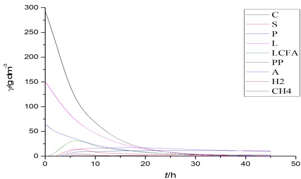
**Slika 5.3.** Simulacija matematičkog modela procesa proizvodnje bioplina anaerobnom razgradnjom – kodigestijom smjese sirutke i goveđe gnojovke (omjer 10:90)
