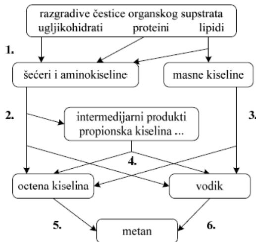
**Slika 2.1.** Shema reakcijskog sustava<sup>12</sup> procesa anaerobne razgradnje (digestije) (1. hidroliza; 2. fermentacija; 3. anaerobna oksidacija; 4. acetogeneza; 5. metanogeneza na octenoj kiselini; 6. metanogeneza na vodiku)
