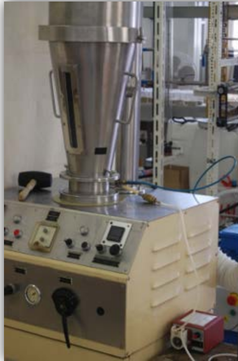
Slika 3.1. Granulator s fluidiziranim slojem Uni-Glatt (Glatt GmbH, Binzen, Njemačka).
