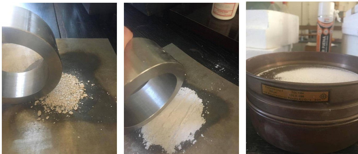
Slika 16. Ručno drobljenje uzoraka te prosijavanje
