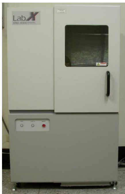
Slika 17. Uređaj za rendgensku difrakcijsku analizu
