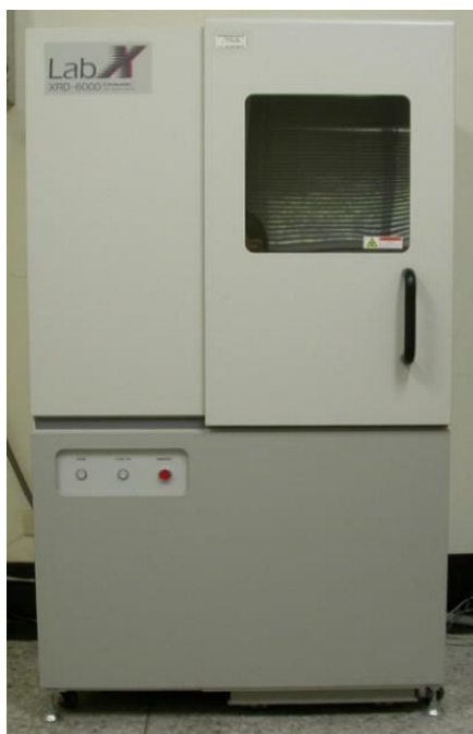
Slika 17. Uređaj za rendgensku difrakcijsku analizu
