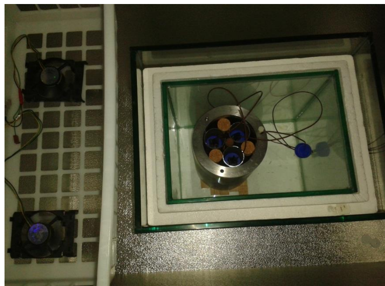
Slika 11. Pregled stakleno - stiroporne konstrukcije smještene u škrinju
