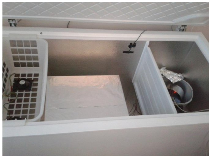
Slika 13. Aparatura za mjerenje oslobođene topline prilikom hidratacije
