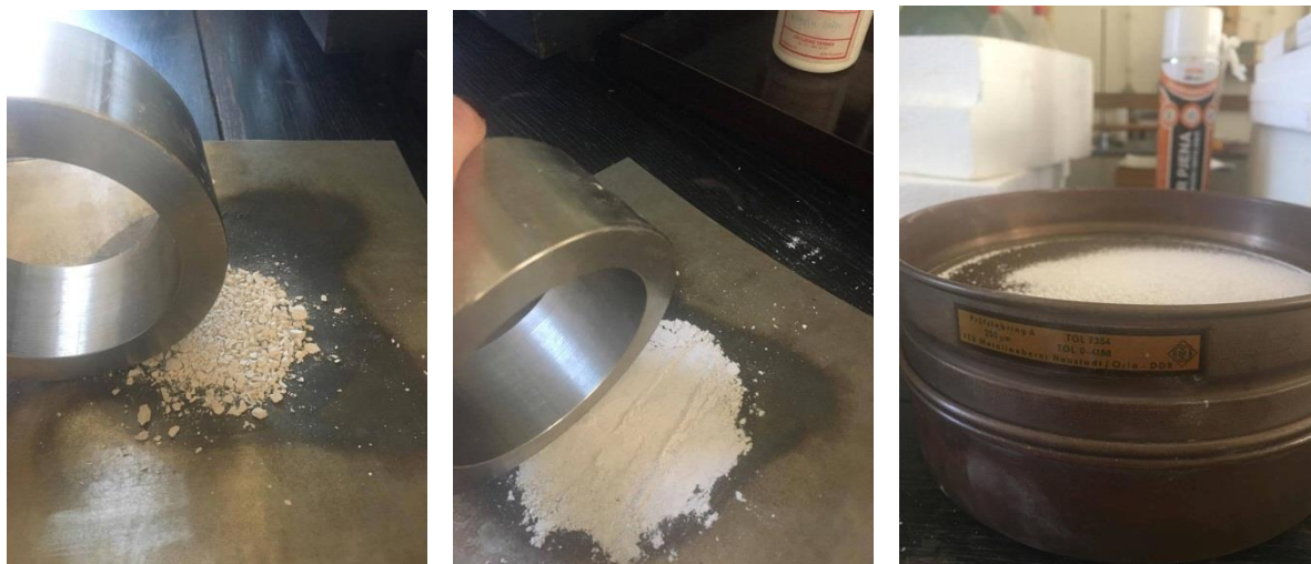
Slika 16. Ručno drobljenje uzoraka te prosijavanje
