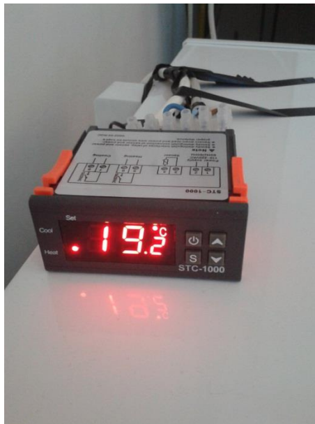
Slika 9. Termostat za regulaciju temperature u škrinji
