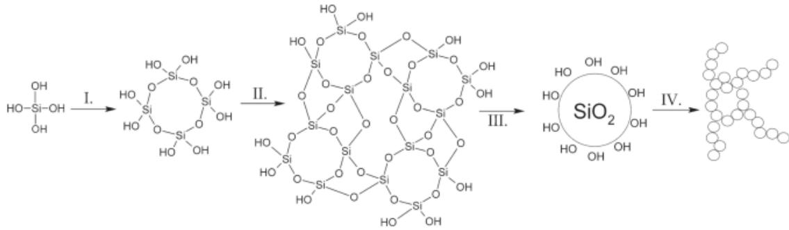
**Slika 7.** Shema kondenzacije hidroliziranih silicijevih alkoksida: I. Kondenzacija monomera u cikličke strukture, II. Nastajanje trodimenzionalnih  $\text{SiO}_2$  čestica, III. Rast  $\text{SiO}_2$  čestica, IV. Povezivanje čestica u trodimenzijsku neprekinutu mrežu, tj. gel [12]
