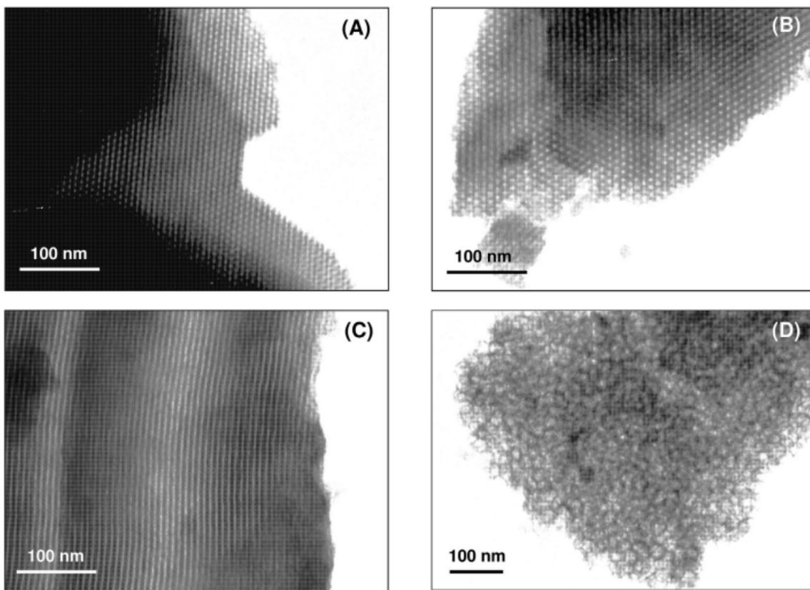
**Slika 2.** Transmisijske elektronske mikrografije odabralih mezoporoznih materijala:
