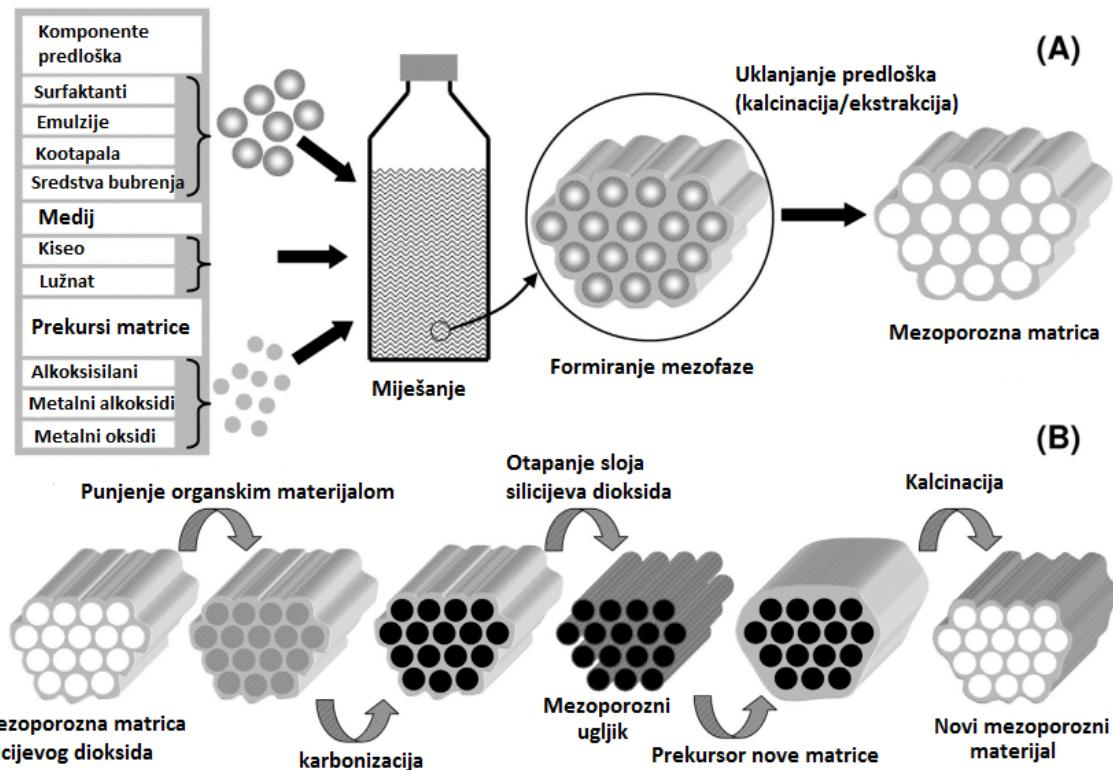
**Slika 5.** Shematski prikaz glavnih pristupa sintezi mezoporoznih materijala. (A) Metoda mekog predloška, (B) metoda tvrdog predloška [1]
