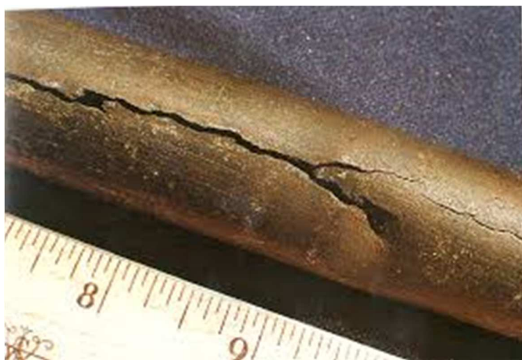
Slika 2.12. Primjer korozijskog raspucavanja uz naprezanje
