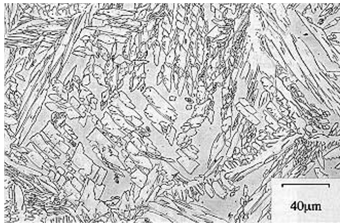
Slika 2. 4. Mikrostruktura dupleks čelika
