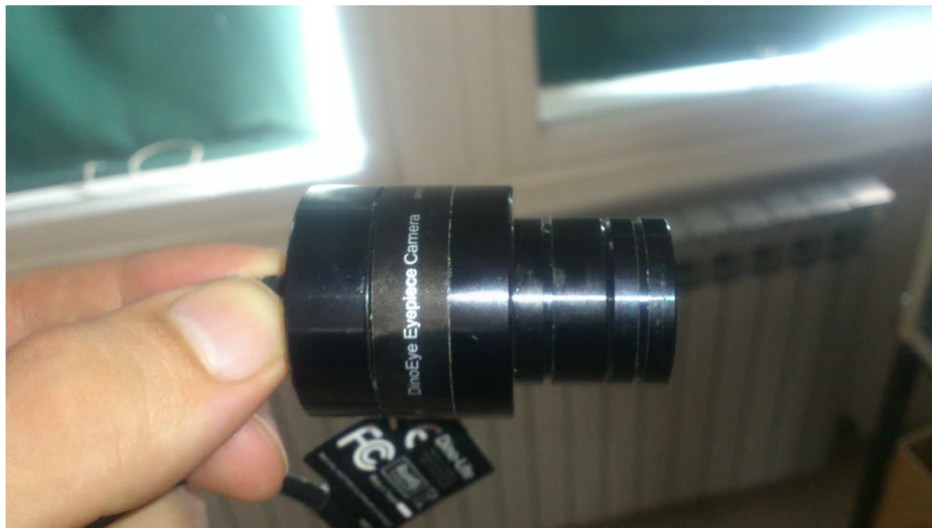
Slika 3.11. Digitalna kamera DinoEye Eyepiece za optički mikroskop
