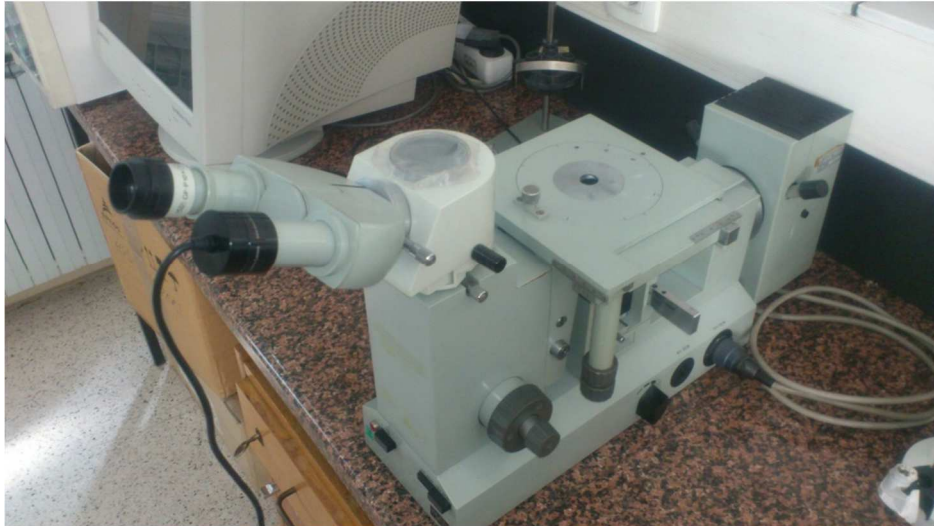
Slika 3.12. Optički mikroskop s ugrađenom digitalnom kamerom
