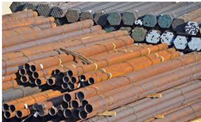
Slika 2.5. Primjer jednolike korozije na površini čeličnih cijevi
