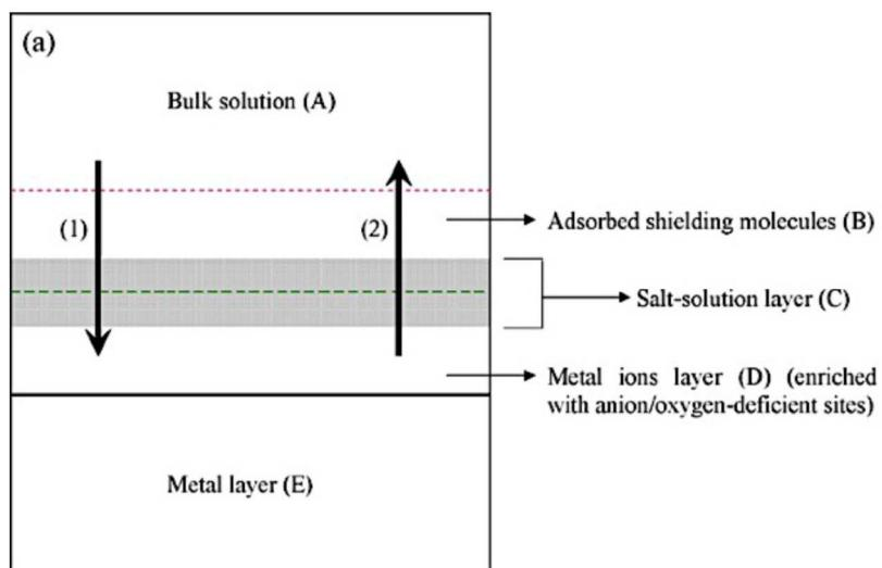
**Slika 5.2.** Shematski prikaz modela anodnog otapanja metala
