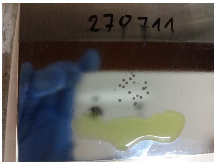
Slika 5.6. Uzorak 27071 površinske hrapavosti R_a = 0,19 \mu\text{m} ( \Delta R_a = 0,01 \mu\text{m} ) i polarizacijskog otpora R_p = 1690 \text{ k}\Omega \text{ cm}^2
