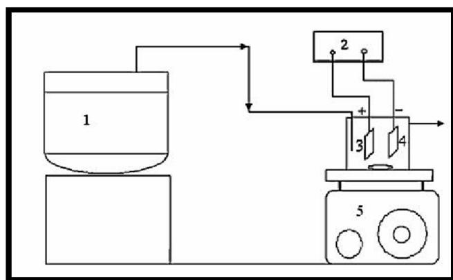
**Slika 2.13.** Shematski prikaz osnovnih dijelova elektrokemijskog reaktora (1- spremnik elektrolita, 2- izvor istosmjerne struje, 3- anoda, 4- katoda, 5- magnetna miješalica)
