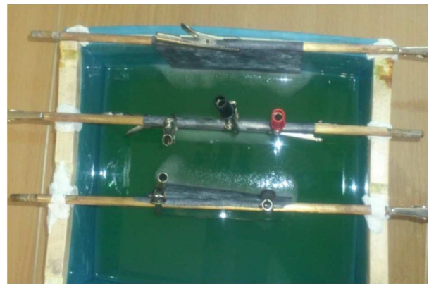
Slike 3.1. i 3.2. Prikazi elektrokemijskog reaktora korištenog za proces elektropoliranja
