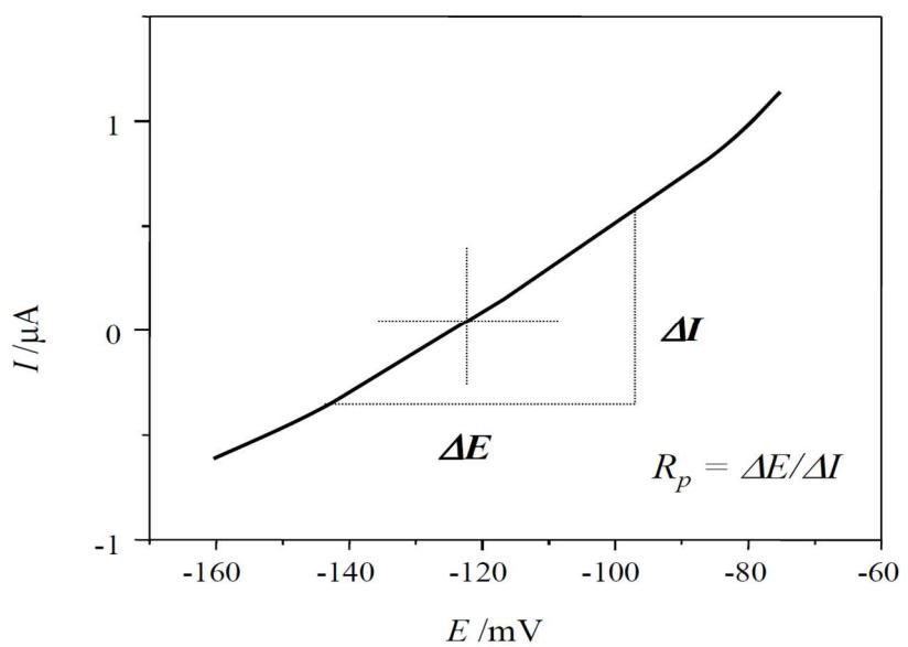
**Slika 2.20.** Određivanje polarizacijskog otpora prema F. Mansfeldu
