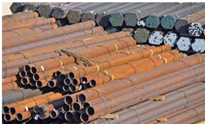
**Slika 2.5.** Primjer jednolike korozije na površini čeličnih cijevi
