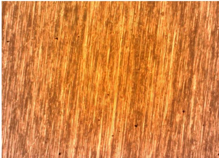
**Slika 4.14.** Prikaz površine metala prije procesa elektropoliranja (povećanje 200x)
