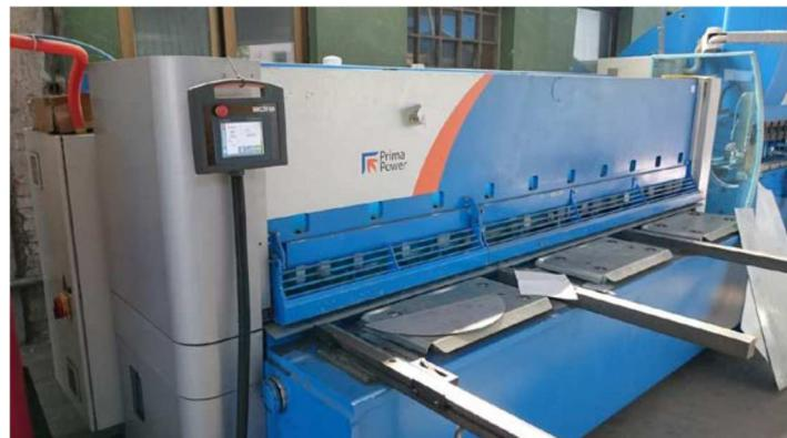
**Slika 3.3.** Hidrauličke CNC škare za rezanje lima
