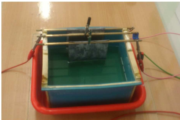
Slike 3.1. i 3.2. Prikazi elektokemijskog reaktora korištenog za proces elektropoliranja
