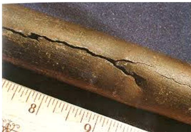
Slika 2.12. Primjer korozijskog raspucavanja uz naprezanje
