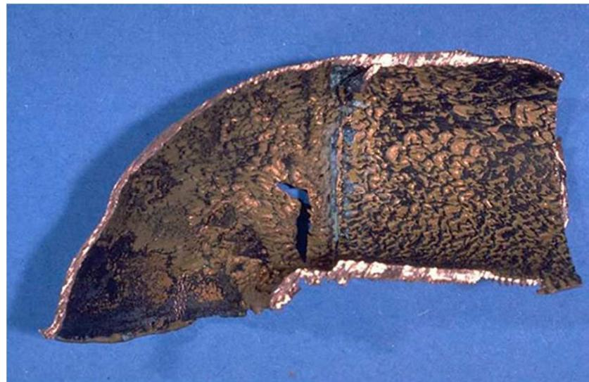
**Slika 2.11.** Primjer erozijske korozije na unutrašnjosti bakrene cijevi
