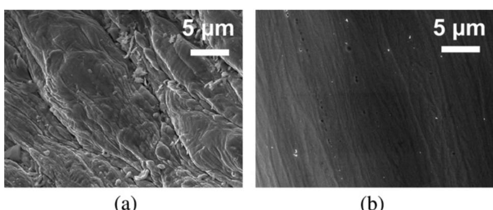
Slika 2.16. SEM prikaz unutarnje površine igle: a) prije elektropoliranja; b) nakon elektropoliranja<sup>[9]</sup>
