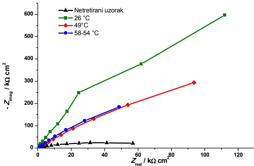
**Slika 4.7.** Nyquistov prikaz EIS zabilježen za netretiranu čeličnu elektrodu i čelične elektrode tretirane pri različitim temperaturama elektrolita
