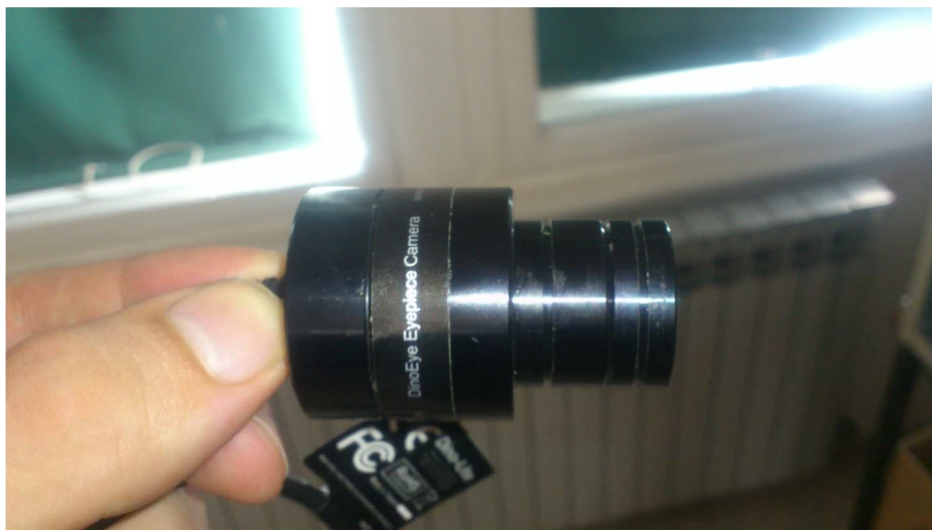
Slika 3.11. Digitalna kamera DinoEye Eyepiece za optički mikroskop
