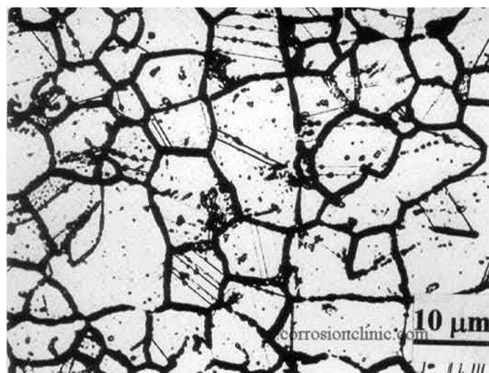
Slika 2.9. Primjer interkristalne korozije na granicama zrna metala
