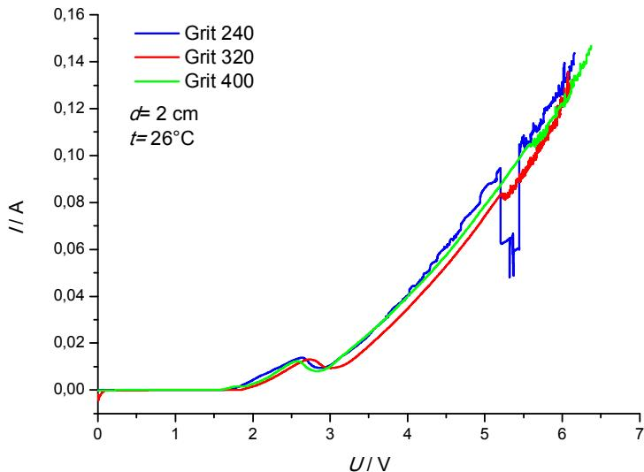
**Slika 4.13.** Anodne polarizacijske krivulja čelika AISI 316L u otopini za elektropoliranje zabilježena za tri različite vrijednosti finoće brusnoga papira kojima su uzorki bili prethodno tretirani ( $v=2 \text{ mV s}^{-1}$ )
