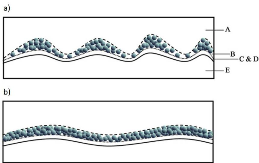
**Slika 5.3.** Shematski prikaz organskih molekula adsorbiranih na površini elektrode u slučaju:
