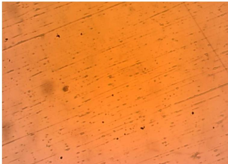
**Slika 4.18.** Prikaz površine metala tretiranog prilikom snimanja anodne polarizacijske krivulje
