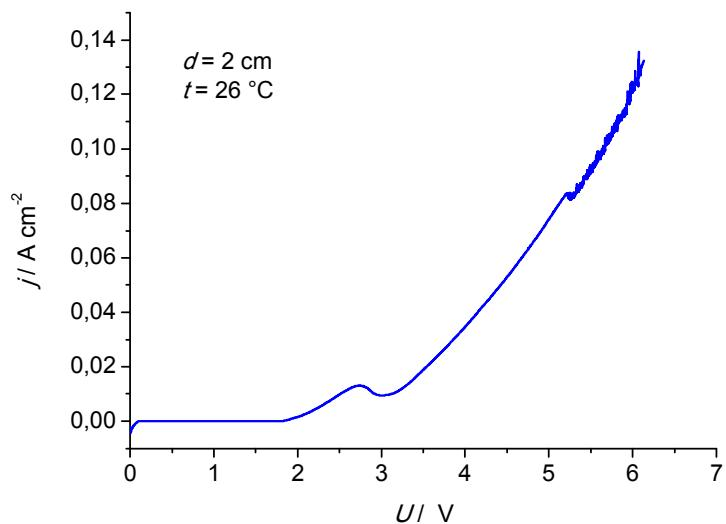
Slika 4.1. Anodna polarizacijska krivulja čelika AISI 316L u otopini za elektropoliranje ( $v=2 \text{ mV s}^{-1}$ )
