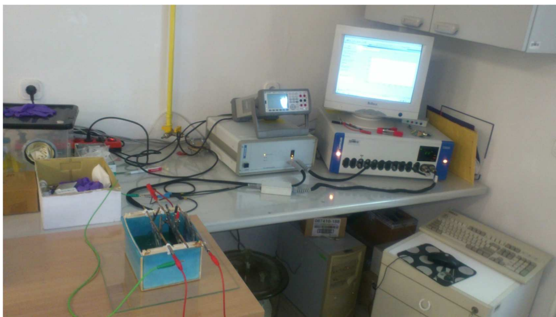
Slika 3.7. Snimanje anodne polarizacijske krivulje na Autolab potenciostatu uz pomoć Boostera10A
