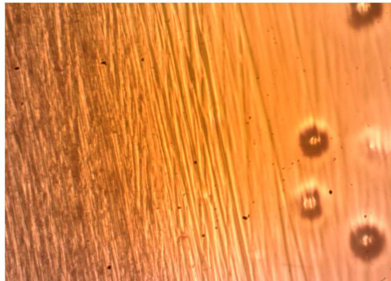
**Slika 4.16.** Prikaz površine metala na prijelazu između tretiranog i netretiranog dijela uzorka (povećanje 1600x)
