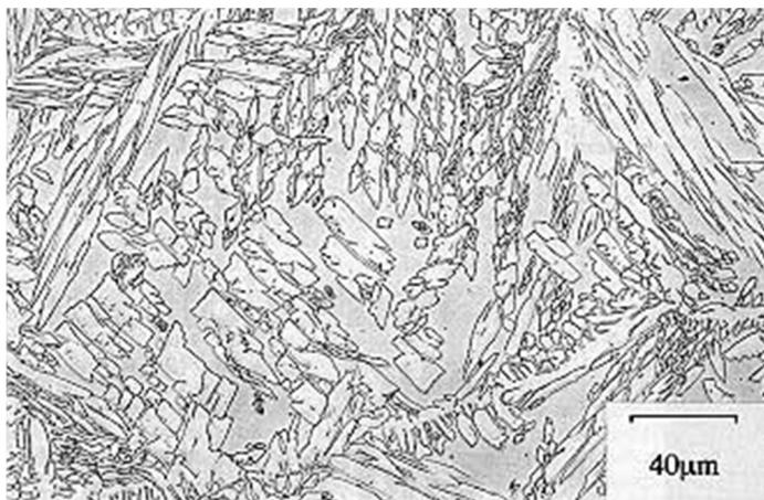
**Slika 2. 4.** Mikrostruktura dupleks čelika
