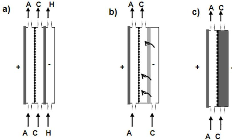
**Slika 2.15.** Prikaz različitih modifikacija reaktora tipa filter preše - u a) primjeru dodatno je ugrađen izmjenjivač topline dok je u b) i c) primjerima ugrađena 3D elektroda u različitim izvedbama ( b ) strujanje preko elektrode, c) strujanje kroz elektrodu)
