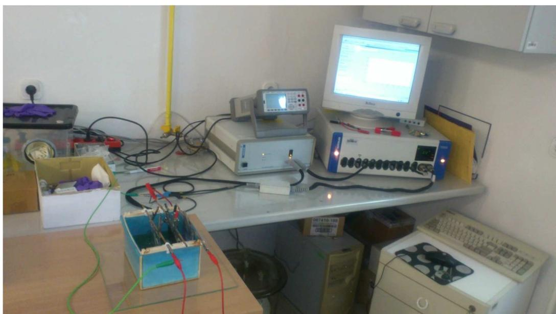
**Slika 3.7.** Snimanje anodne polarizacijske krivulje na Autolab potencijostatu uz pomoć Boostera10A
