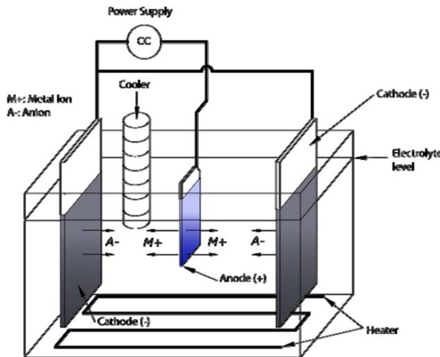
**Slika 2.17.** Shematski prikaz elektrokemijskog reaktora za elektropoliranje
