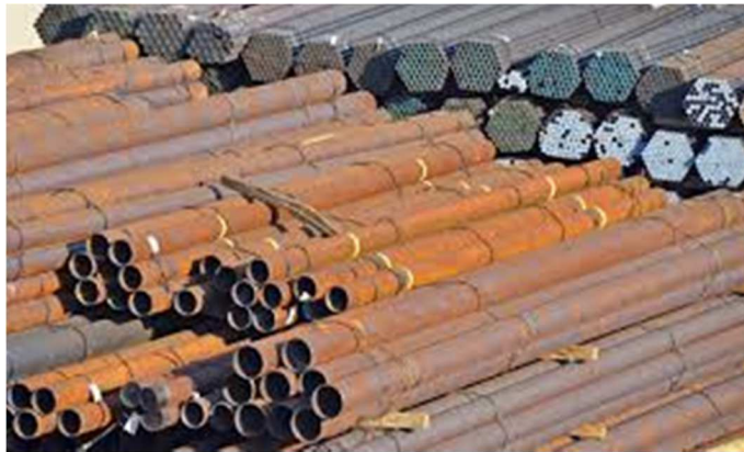
Slika 2.5. Primjer jednolike korozije na površini čeličnih cijevi
