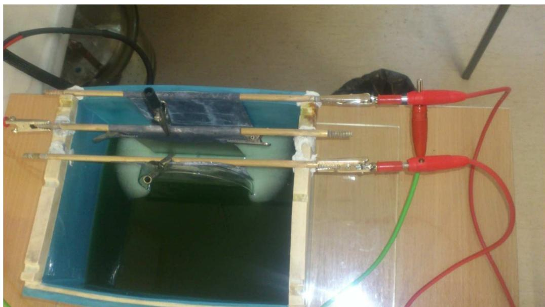
**Slika 3.6.** Prikaz reaktora za vrijeme procesa elektropoliranja
