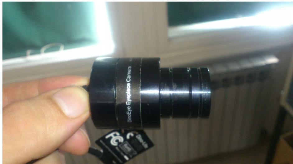
Slika 3.11. Digitalna kamera DinoEye Eyepiece za optički mikroskop
