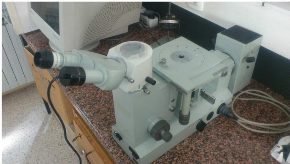
**Slika 3.12.** Optički mikroskop s ugradenom digitalnom kamerom
