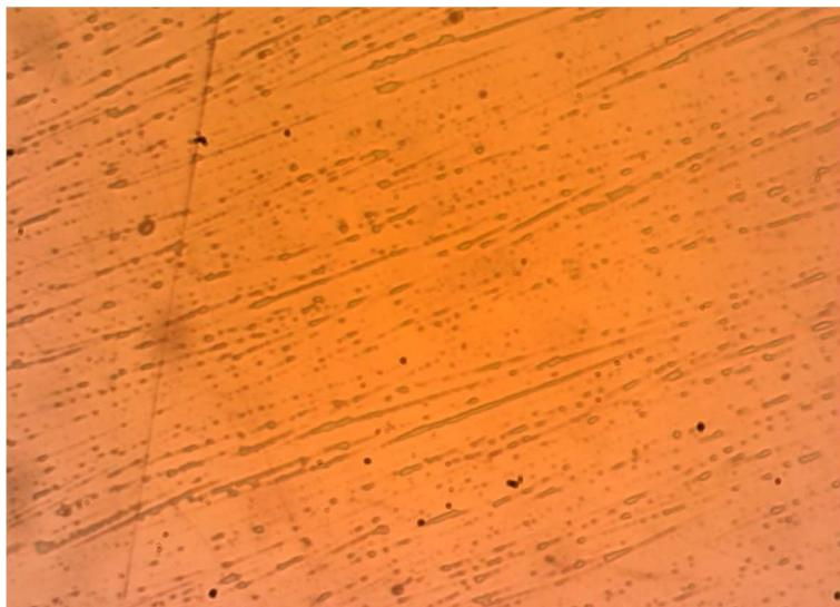
**Slika 4.15.** Prikaz površine metala tretiranog prilikom snimanja anodne polarizacijske krivulje (povećanje 200x)
