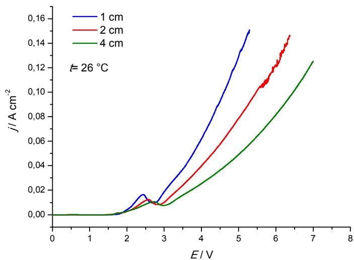
**Slika 4.9.** Anodne polarizacijske krivulje čelika AISI 316L u otopini za elektropoliranje zabilježena kod tri različita razmaka između elektroda ( $v=2 \text{ mV s}^{-1}$ )
