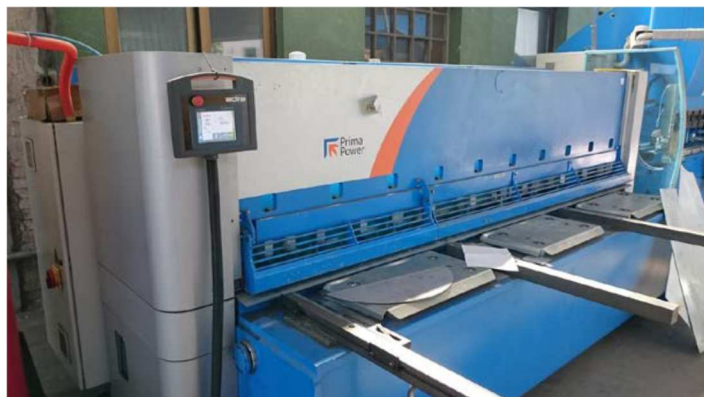
Slika 3.3. Hidrauličke CNC škare za rezanje lima
