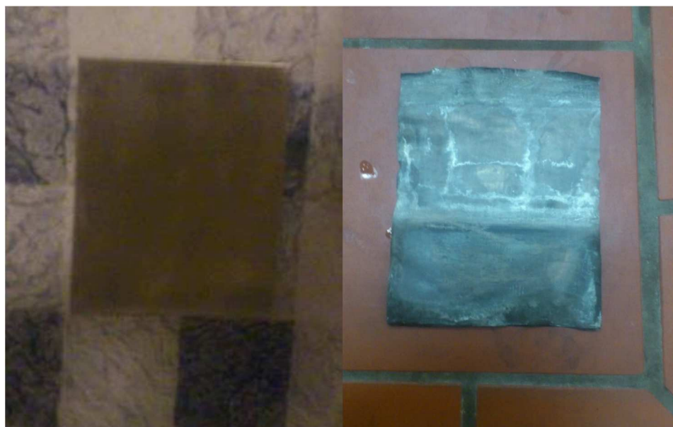
Slika 3.5. Prikaz čelične anode (lijevo) i olovne katode (desno)
