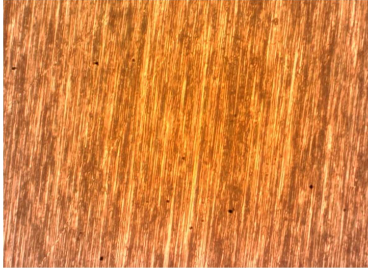
Slika 4.14. Prikaz površine metala prije procesa elektropoliranja (povećanje 200x)
