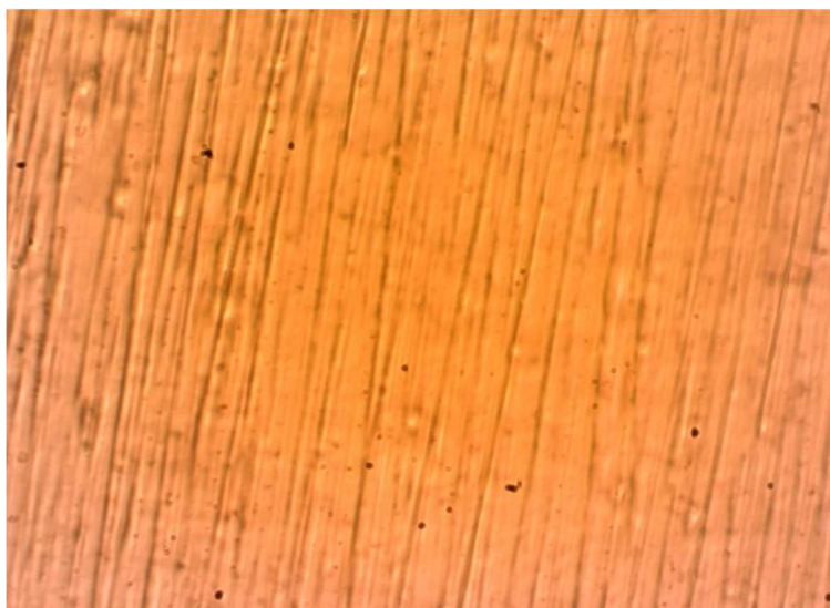
Slika 4.17. Prikaz površine metala uzorka tretiranog 15 minuta pri sobnoj temperaturi (povećanje 800x)
