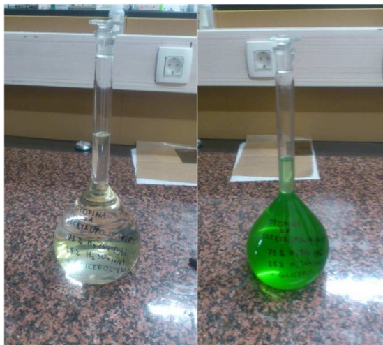
Slika 3.4. Otopina za elektropoliranje prije (lijevo) i nakon (desno) prvog korištenja
