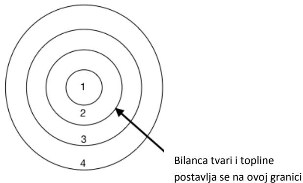
Legend: 1 - Reaktor; 2 – Separacijske jedinice; 3 - Mreže izmjenjivača topline; 4 – Pomoćne struje u sustavu
