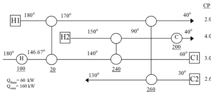
**Slika 2.23.** Dizajn mreže s minimalnim brojem izmjenjivača topline
