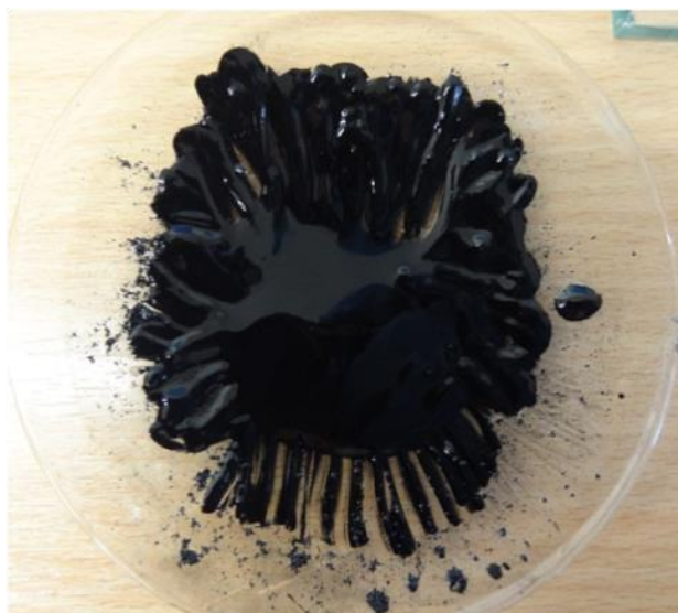
Slika 14. Pasta dobivena praškaste smjese AC, CB i PVDF s određenom količinom otapala NMP
