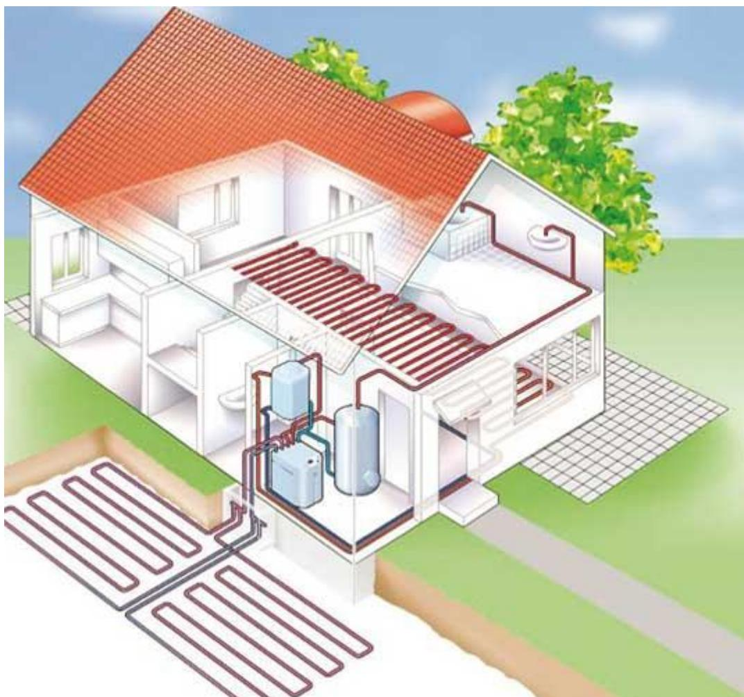
Slika 5. Horizontalno položen izmjenjivač topline (paralelna konfiguracija)
