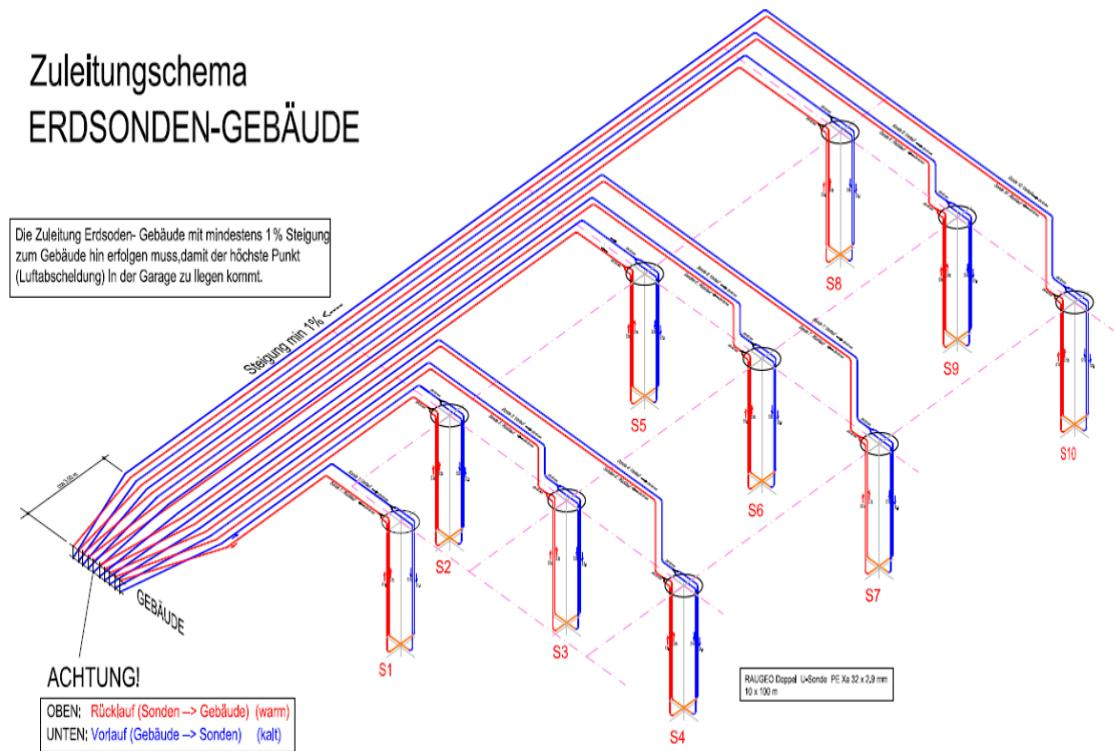
Slika 9. Shema izmjenjivača topline geotermalne dizalice topline u sustava grijanja poslovno-stambene zgrade „Agria“ [19].
