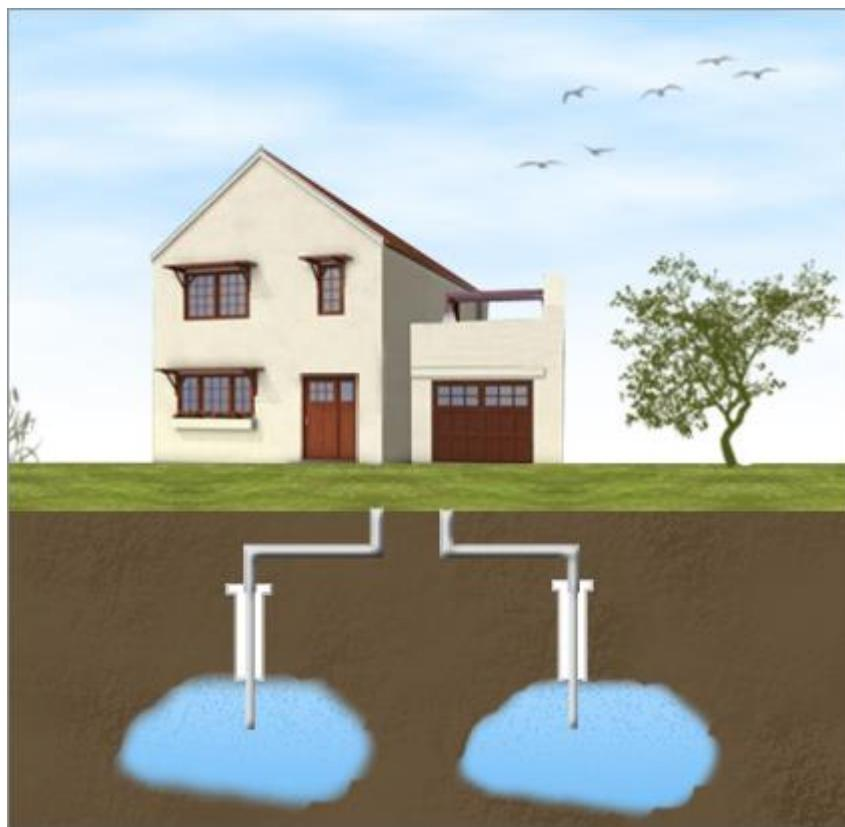
Slika 6. Geotermalne dizalice topline sa otvorenim krugom [2].
