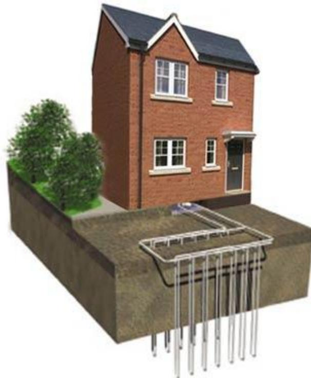
Slika 4. Vertikalno postavljen izmjenjivač topline u sustavu sa zatvorenim krugom [17].
