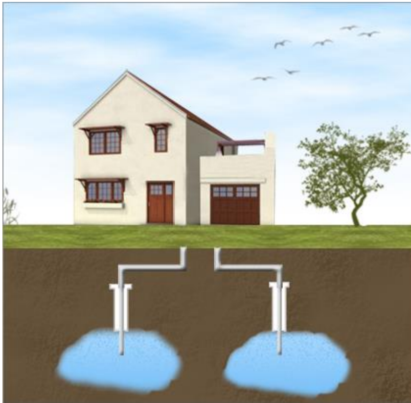
Slika 6. Geotermalne dizalice topline sa otvorenim krugom [2].
