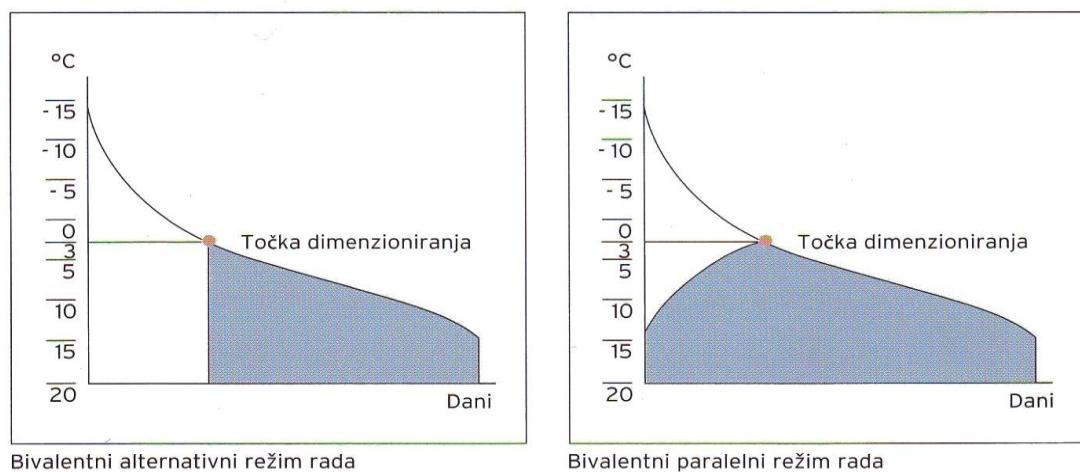
Slika 8. Bivalentni alternativni/ paralelni režim rada dizalice topline [5].
