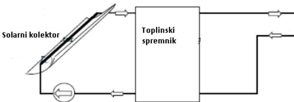
Slika 2.6. Prikaz solarnog kolektora i dijagram toka fluida unutar solarnog sustava hlađenja [18].
