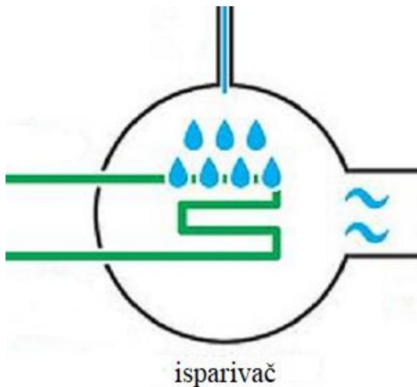
Slika 2.18. Prikaz isparivača u apsorpcijskom sustavu hlađenja [20].
