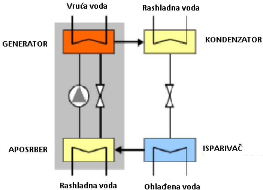
Slika 2.12. Princip rada izmjenjivača topline u apsorpcijском sustavu hlađenja.
