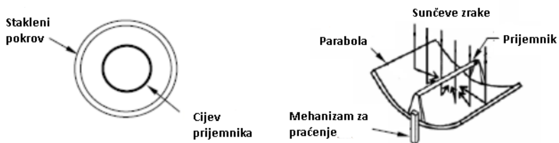
Slika 2.7. Presjek i shema paraboličog kolektora; parabolički kolektor sastoji se od parabole, mehanizma za praćenje i prijemnika [16].
