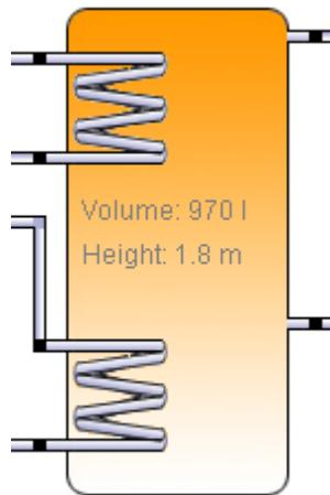
Slika 3.7. Prikaz spremnika s toploim vodom u programu „Polysun“.
