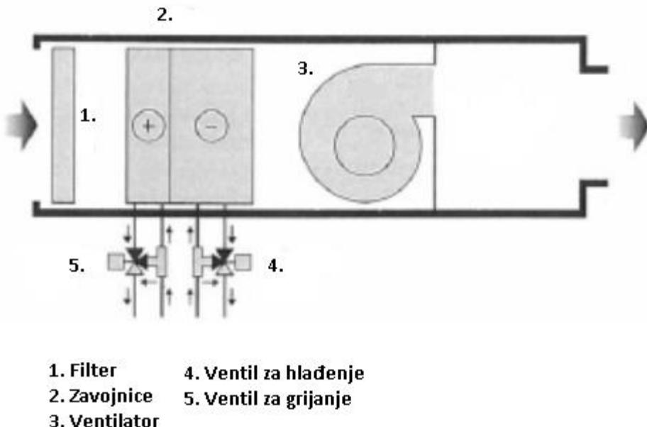
Slika 2.25. Shematski prikaz ventilokonvektora sa 4 cijevi [21].
