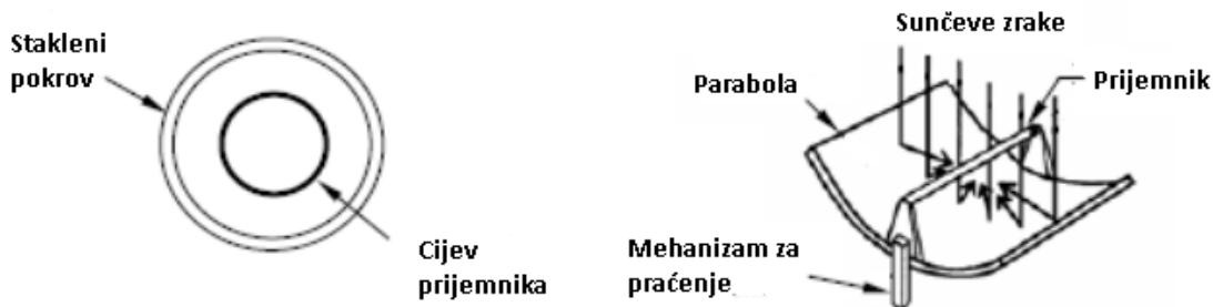
Slika 2.7. Presjek i shema paraboličnog kolektora; parabolički kolektor sastoji se od parabole, mehanizma za praćenje i prijemnika [16].
