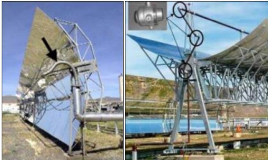
Slika 11. Prikaz fleksibilne cijevi i kuglastog zgloba [10]
