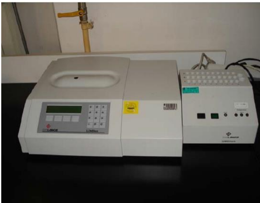
Slika 9. Instrument za provedbu toksičnosti LUMIStox 300 s termostatiranim blokom LUMIStherm
