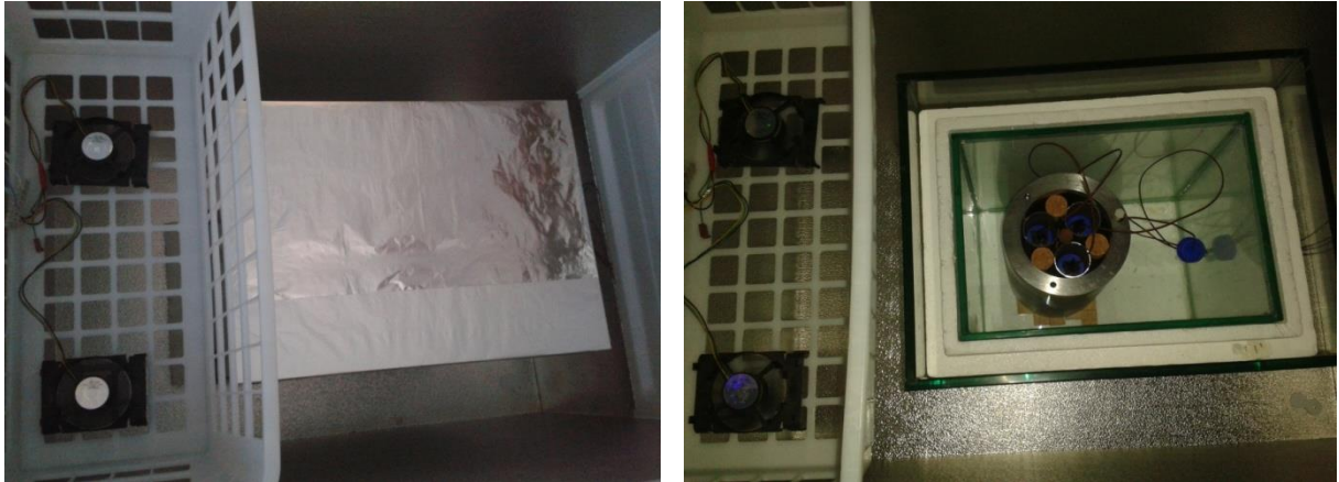
Slika 22. Unutrašnjost škrinje sa ventilatorima (lijevo), stakleno-stiroporna konstrukcija sa kivetama (desno)
