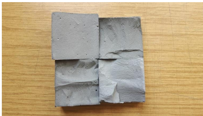
Slika 25. Uzorci prizmi Portland cementa „Našice“ (gore lijevo, dolje desno), i bušotinskog cementa (gore desno, dolje lijevo)
