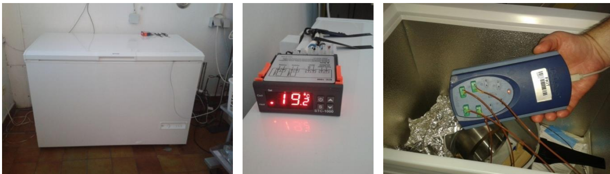
Slika 21. Škrinja za zamrzavanje (lijevo), termostata za regulaciju temperature (sredina), uređaj za prikupljanje podataka (desno)
