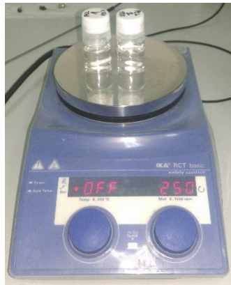
Slika 5. Polimerna otopina PCL-a na magnetskoj miješalici
