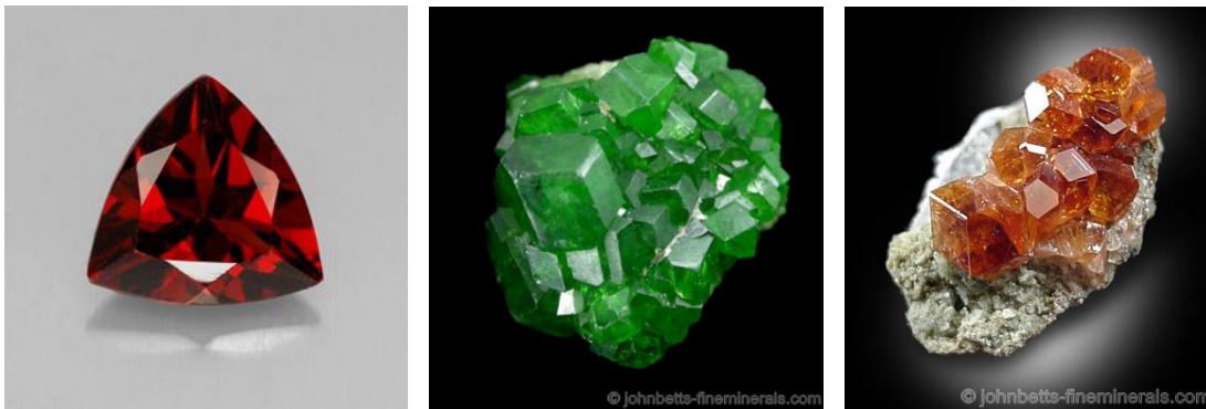
Slika 8-10.S lijeva na desno: Mg_3Al_2Si_3O_{12} , Ca_3Cr_2Si_3O_{12} , Ca_2Al_2Si_3O_{12} [20-22]
