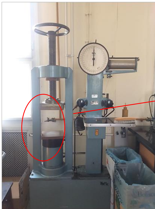
Slika 19. Hidraulička preša za određivanje čvrstoće na tlak
