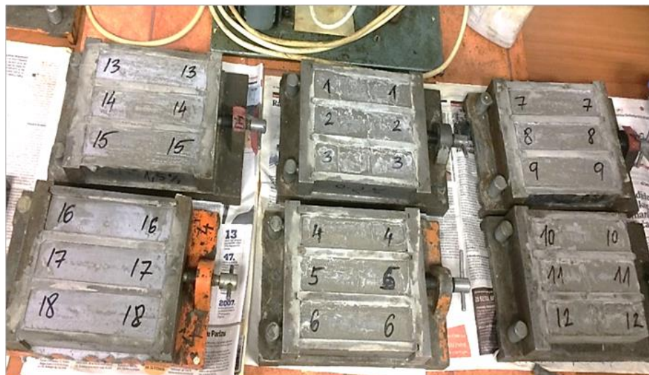
Slika 35. Kalupi s različitim koncentracijama usporivača
