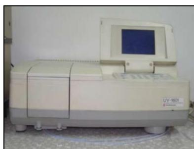
Slika 3.3. Spektrofotometar *Shimadzu UV – 1601*
