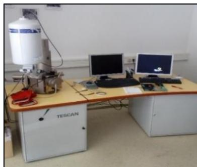
Slika 3.10. SEM – EDS *Tescan Vega 5136 MM*
