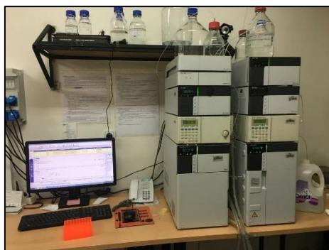
Slika 3.5. HPLC *Shimadzu* modularni sustav
