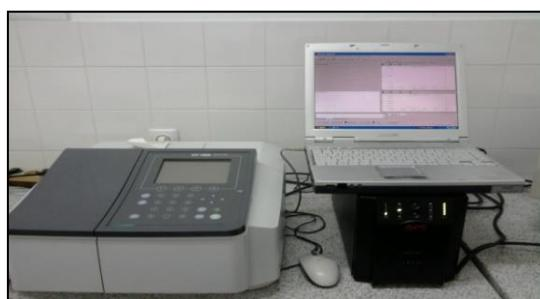
Slika 3.4. Spektrofotometar *Shimadzu UV – 1800*
