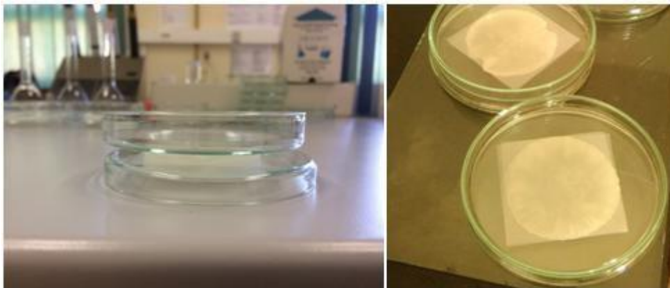
Slika 3.3. Sušenje dehidriranog poroznog nosača pri atmosferskim uvjetima uz pomoć kalupa.
