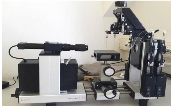
Slika 15. Goniometar, DataPhysics OCA 20 Instrument
