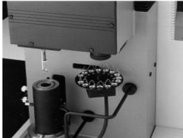
Slika 8. TGA analizator TA Instruments Q500
