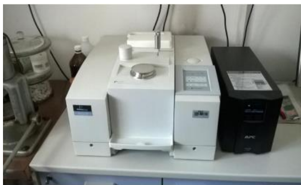
Slika 5. PerkinElmer, Spectrum One spektrometar
