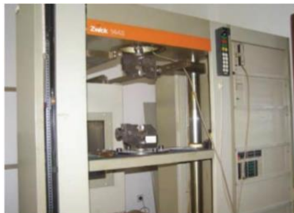
Slika 7. Univerzalna mehanička kitalica ZWICK 1445
