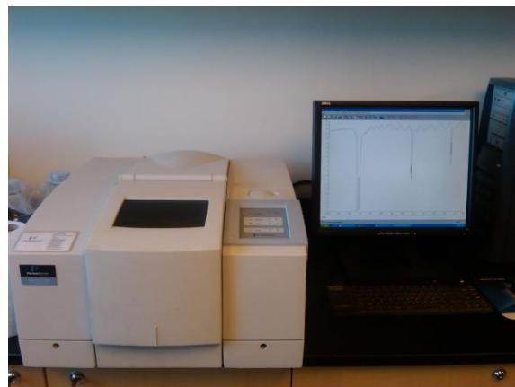
Slika 17. Perkin-Elmer Spectrum One FTIR spektrometar<sup>22</sup>
