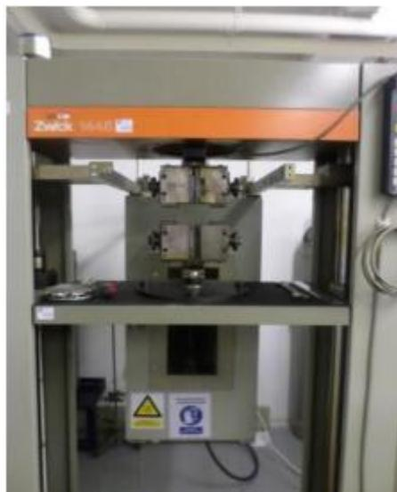
**Slika 19.** Mehanička kidalica Zwick 1445<sup>39</sup>
