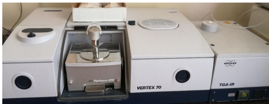
Slika 12. FTIR Bruker Vertex 70
