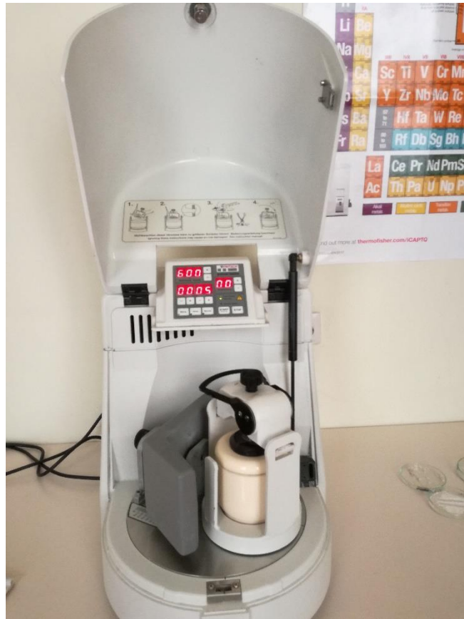
Slika 10. Planetarni mlin Frisch Pulverisette 6
