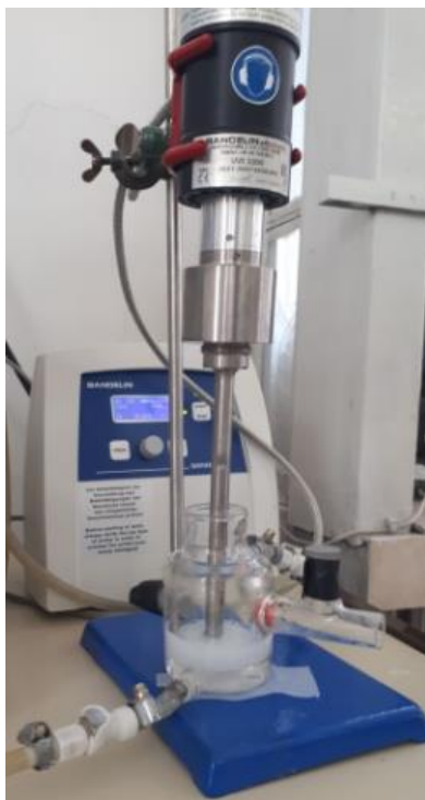
Slika 10. Raspršivanje nanočestica sa ultrazvučnom sondom
