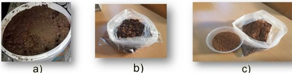
Slika 13. Priprema komine za eksperiment: a) vlažna odmrznuta komina, b) komina nakon sušenja, c) prosijana neoduljena komina i odvojene koštice
