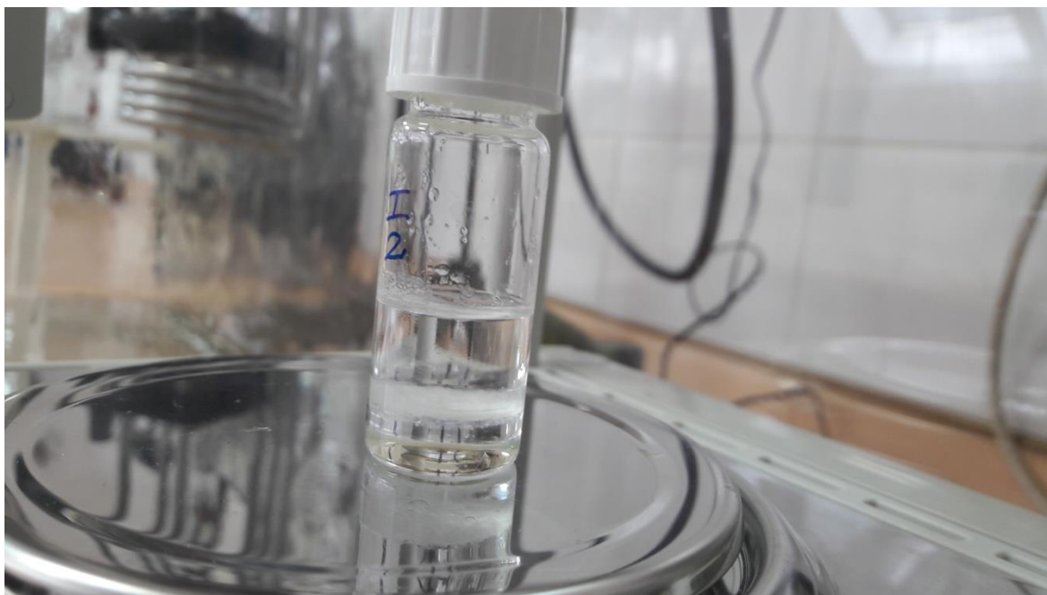
Slika 13. Pojava treće faze i nestabilnost DES-a u sustavu s piridinom i n -heksanom
