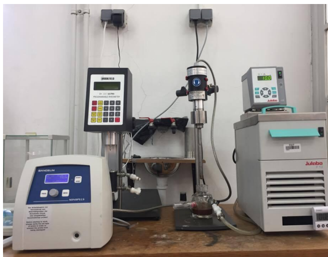
Slika 20. Ultrazvučna sonda Bandelin sonoplus HD 3200
