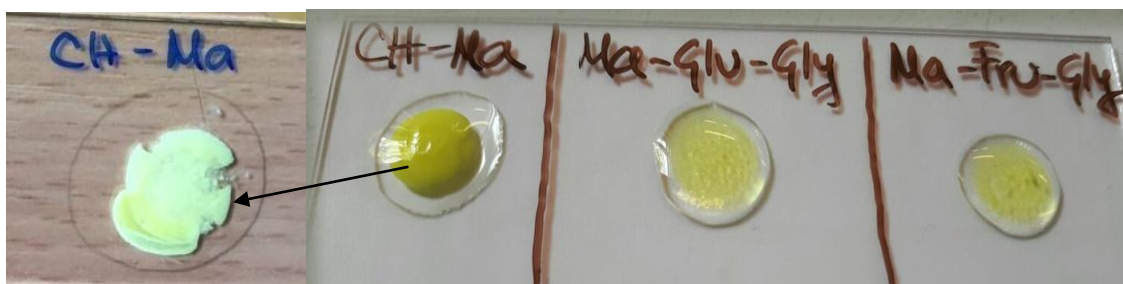
Slika 19. Fotografija taloga nastalog reakcijom Folin-Ciocalteu reagensa i ChCl-Ma
