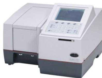
Slika 28. UV Vis spektrofotometar, *Shimadzu* UV-128
