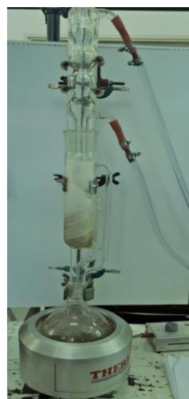
**Slika 23. Aparatura za Soxhlet ekstrakciju**
