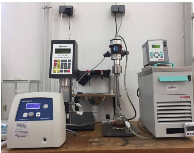
Slika 20. Ultrazvučna sonda *Bandelin sonoplus HD 3200*
