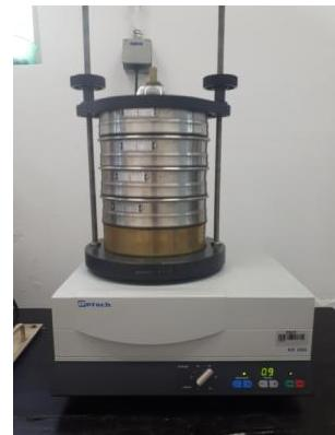
Slika 16. Fotografija uređaja za protresivanje sita AS 200
