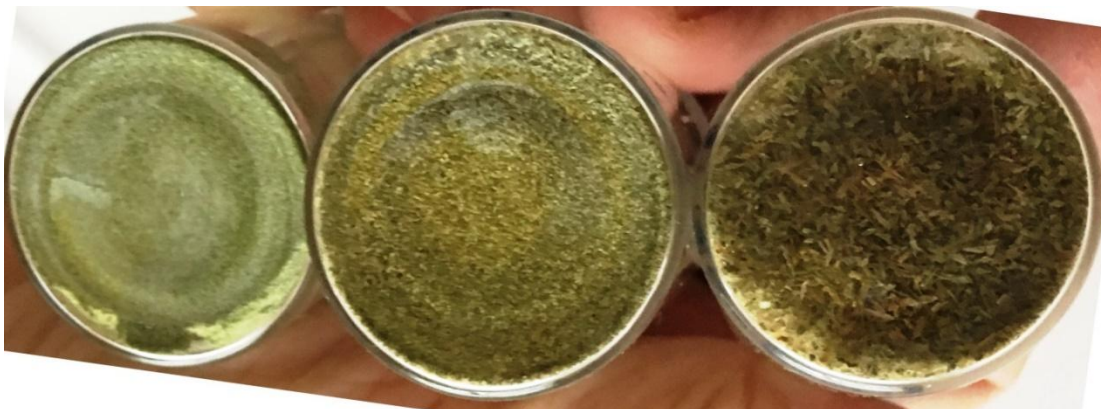
Slika 30. Fotografija različitih frakcija lišća: a) <180 \mu\text{m} , b) <355 \mu\text{m} , c) <710 \mu\text{m}
