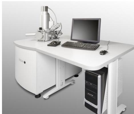
**Slika 18. Uređaj pretražne elektronske mikroskopije, *Tescan Vega 3 SEM***
