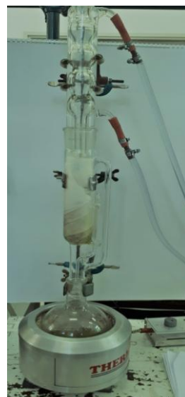
Slika 23. Aparatura za Soxhlet ekstrakciju
