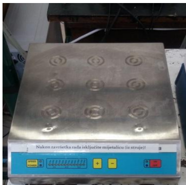
Slika 24. Magnetsko miješalo, Tehtnica Rotamix 609 MM
