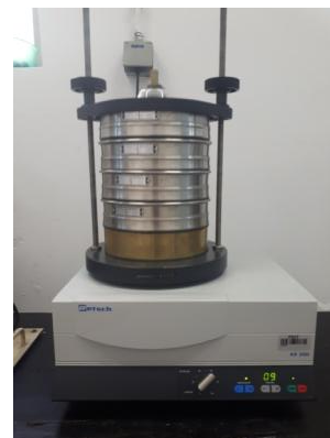
Slika 16. Fotografija uređaja za protresivanje sita AS 200 (Retsch GmbH, Haan, SR Njemačka).
