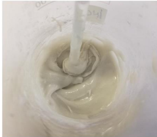
Slika 19. Mješavina rastaljenog PEG-a i DNR-a
