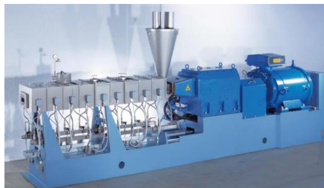
Slika 11. Prikaz pužnog (vijčanog) ekstrudera
