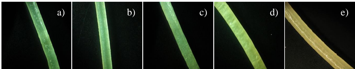
Slika 38. Mikrografija filamenata, uvećanje 16x: a) F5%, b) F10%, c) F15%, d) F20% i e) F10%P
