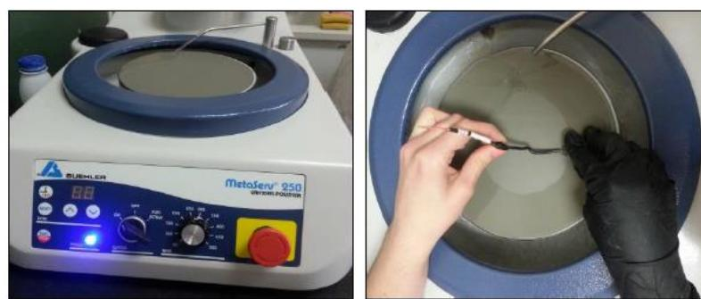
Slika 19. Mehaničko strojno poliranje elektrode
