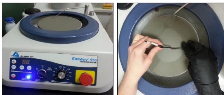
Slika 19. Mehaničko strojno poliranje elektrode
