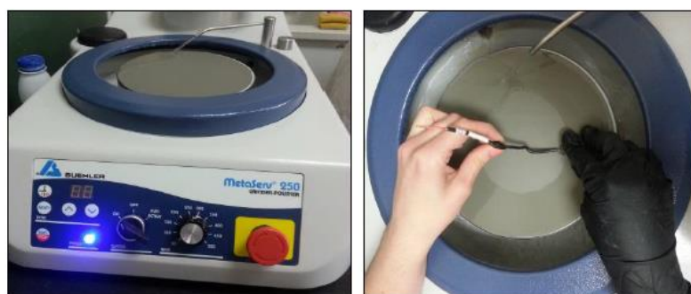
Slika 19. Mehaničko strojno poliranje elektrode
