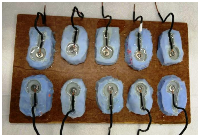
Slika 18. Prikazan postupak izolacije uzoraka legure CuNi dvokomponentnom epoksidnom smolom u silikonskim kalupima
