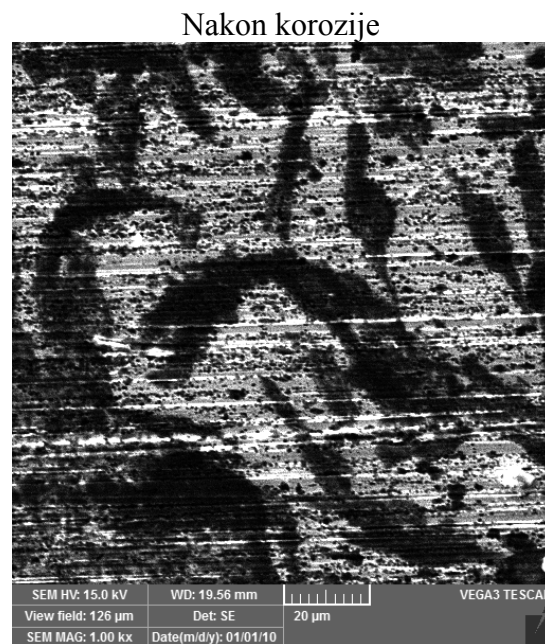
Slika 73. Površina uzorka CuNi 2500 sa debelim filmom
