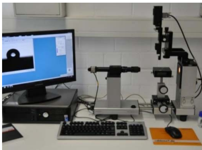
Slika 21. Goniometrar DataPhysics Contant Angle System OCA 20
