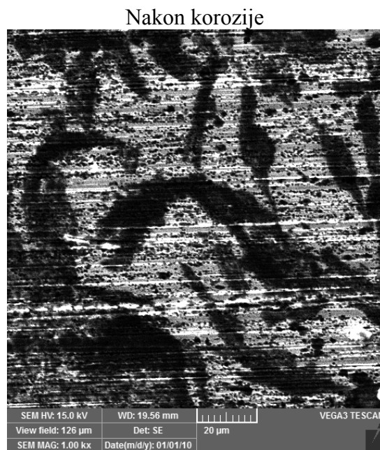
Slika 73. Površina uzorka CuNi 2500 sa debelim filmom
