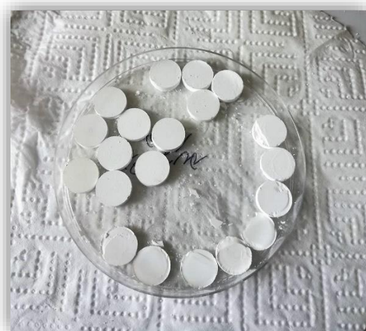
Slika 19. Pastile TiO 2 punila pripravljene prešanjem u kalupu
