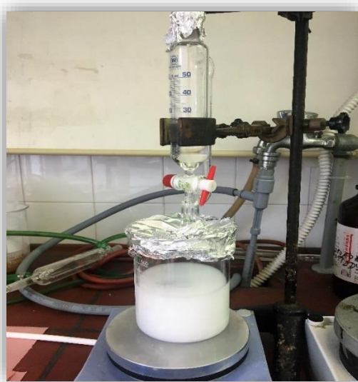
Slika 13. Priprema predemulzije uz dokapavanje monomera kroz lijevak
