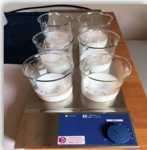
Slika 15. Zamiješavanje BA-co-MMA/nano-SiO 2 i BA-co-MMA/nano-TiO 2 kompozita
