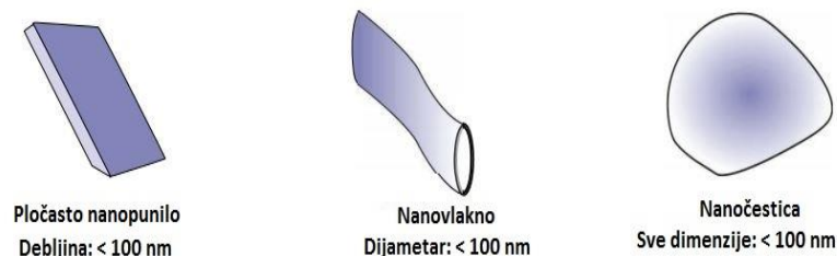
Slika 8. Vrste nanopunila: 1) pločasto punilo, 2) nanovlakno, 3) nanočestica
