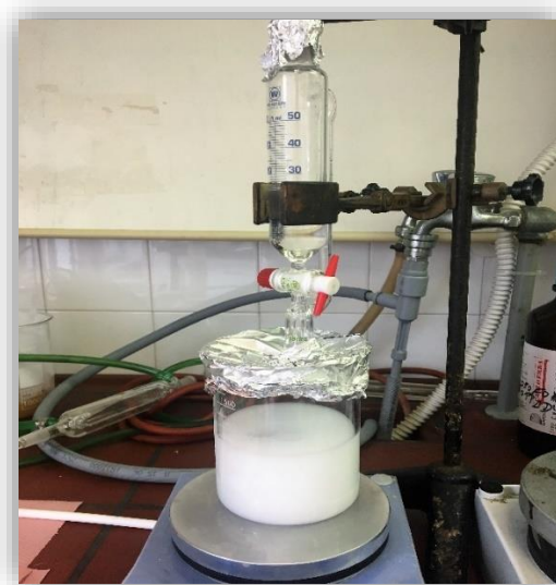
Slika 13. Priprema predemulzije uz dokapavanje monomera kroz lijevak
