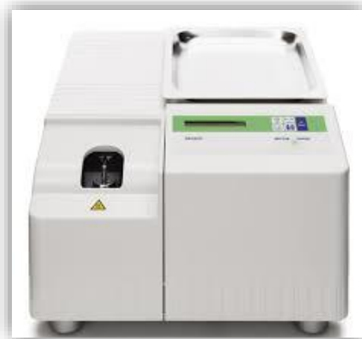
Slika 21. Diferencijalni pretražni kalorimetar, Mettler Toledo DSC 823e 41
