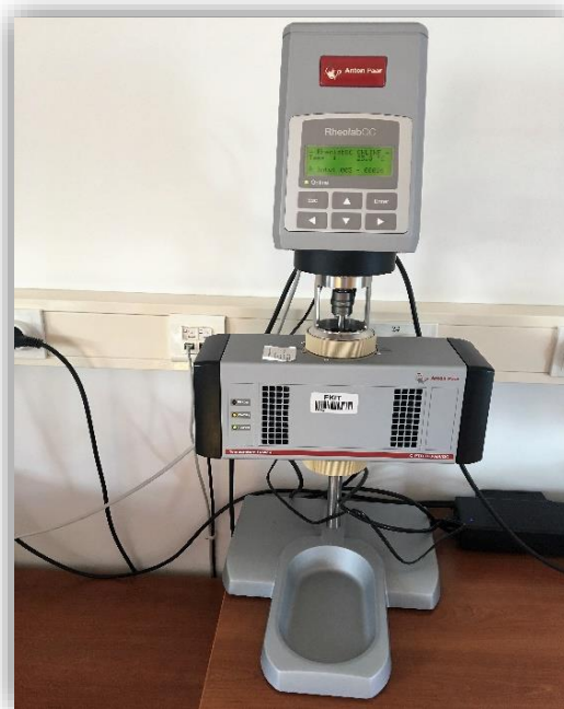
Slika 17. Reometar Anton Paar Rheolab QC
