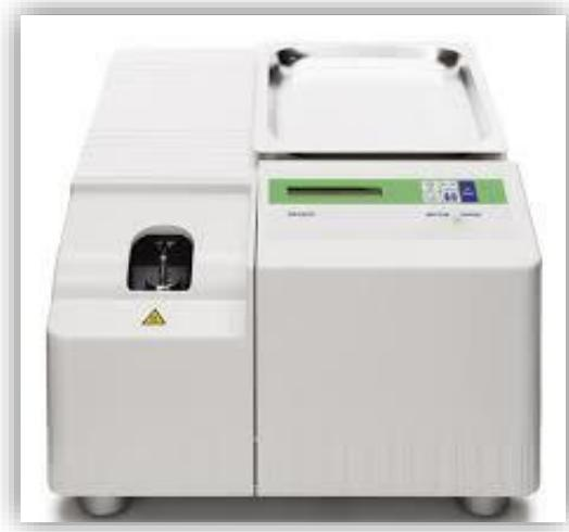
**Slika 21.** Diferencijalni pretražni kalorimetar, Mettler Toledo DSC 823e<sup>41</sup>
