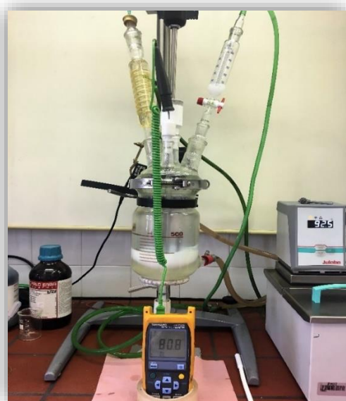
Slika 14. Aparatura za emulzijsku polimerizaciju
