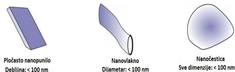
Slika 8. Vrste nanopunila: 1) pločasto punilo, 2) nanovlakno, 3) nanočestica
