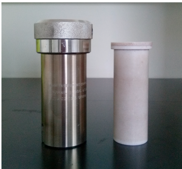
Slika 3.1. Reaktor-autoklav za sintezu i PTFE tuljac.
