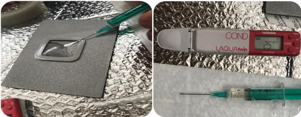
Slika 23. Određivanje slanosti površine
