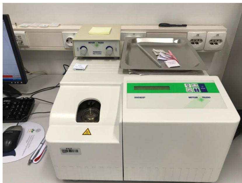
Slika 34. Uređaj za DSC analizu
