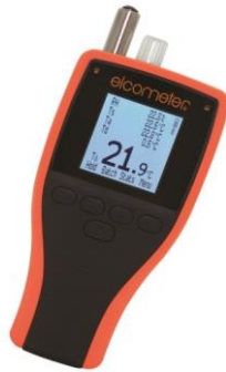
Slika 19. Ispitivanje klimatskih uvjeta pomoću uređaja Elcometer 319
