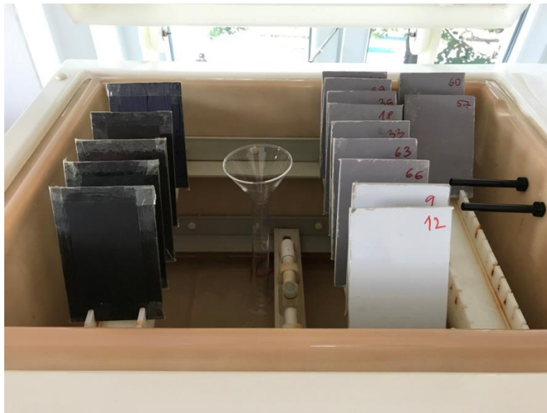
Slika 31. Testne pločice u slanoj komori prije početka ispitivanja (desna strana)
