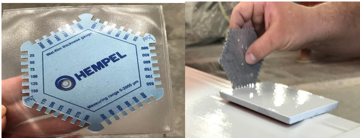
Slika 26. Mjerenje debljine mokrog filma premaza (DMF) češljem
