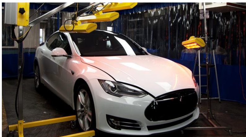
Slika 11. IC sušenje premaza automobila
