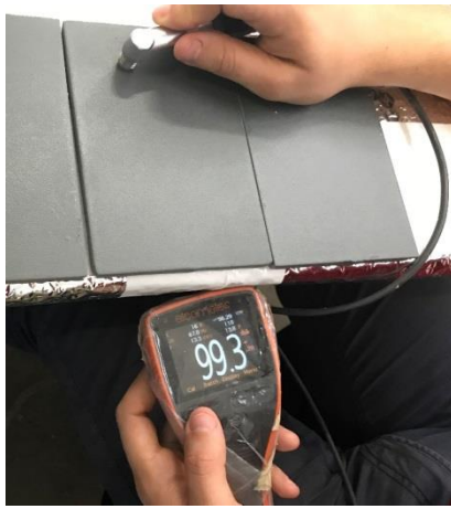
Slika 28. Određivanje DSF pomoću uređaja Elcometar 456
