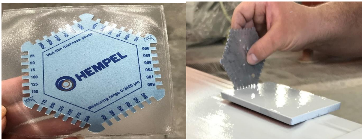
Slika 26. Mjerenje debljine mokrog filma premaza (DMF) češljem
