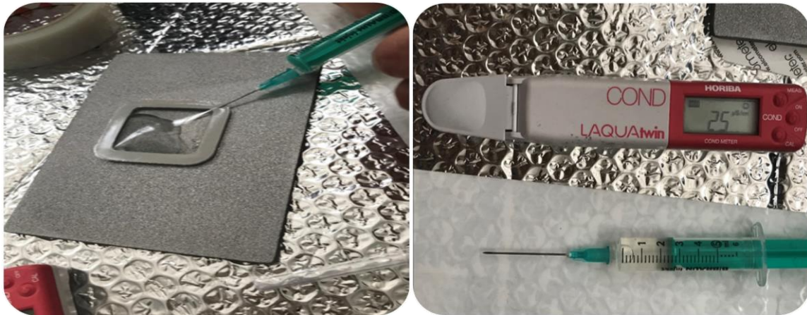
Slika 23. Određivanje slanosti površine
