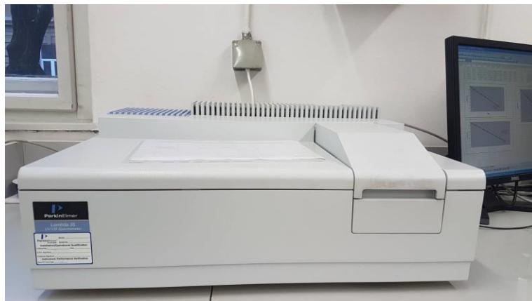
**Slika 10.** Dvozračni UV/VIS spektrofotometar
