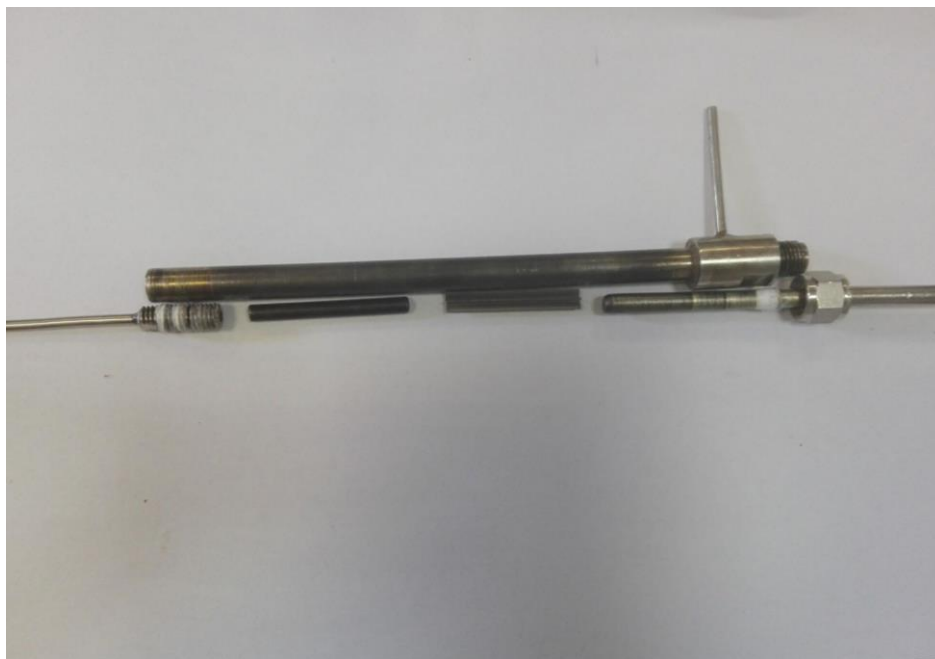
Slika 3.6. Punjenje cijevnog reaktora monolitnim katalizatorom
