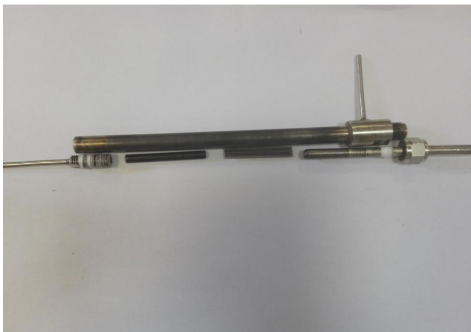
Slika 3.6. Punjenje cijevnog reaktora monolitnim katalizatorom
