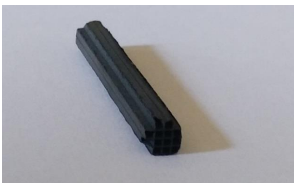
Slika 3.3. Kordijeritni monolitni supstrat nakon nanošenja katalitički aktivne komponente (Mn-CuO x ) i kalciniranja
