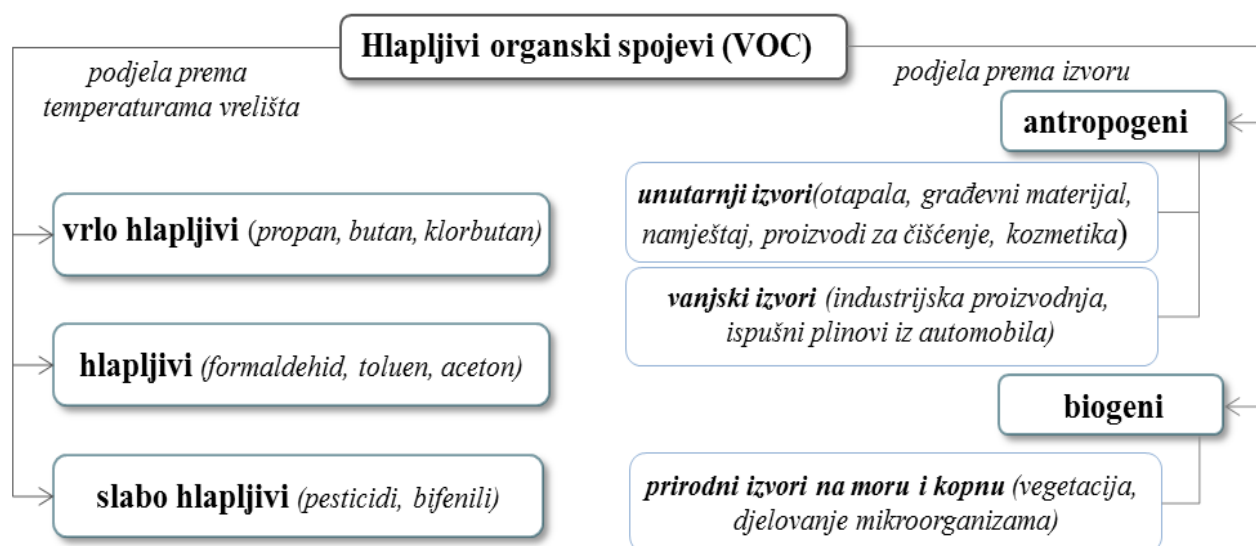
Slika 2.1. Podjela hlapljivih organskih spojeva [1,6,7]
