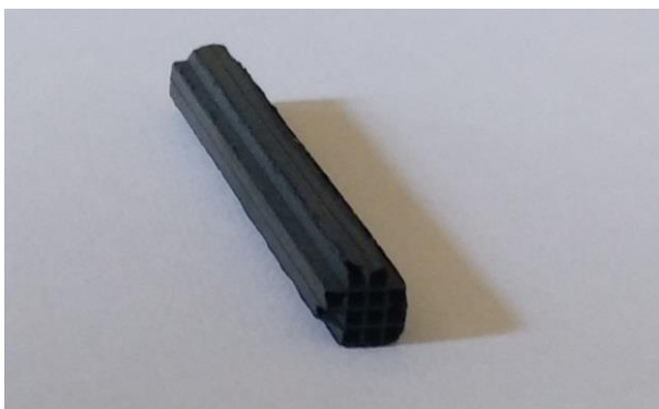
Slika 3.3. Kordijeritni monolitni supstrat nakon nanošenja katalitički aktivne komponente (Mn-CuO x ) i kalciniranja
