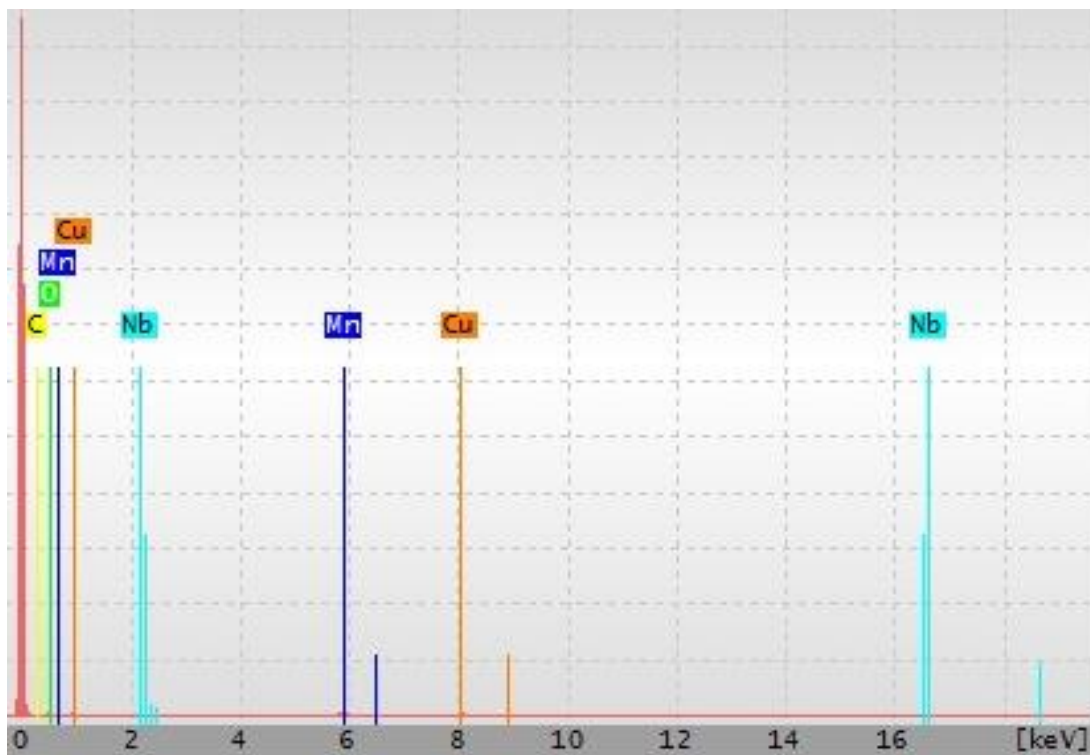
Slika 4.2. Rezultati EDX analize Mn-Cu katalizatora
