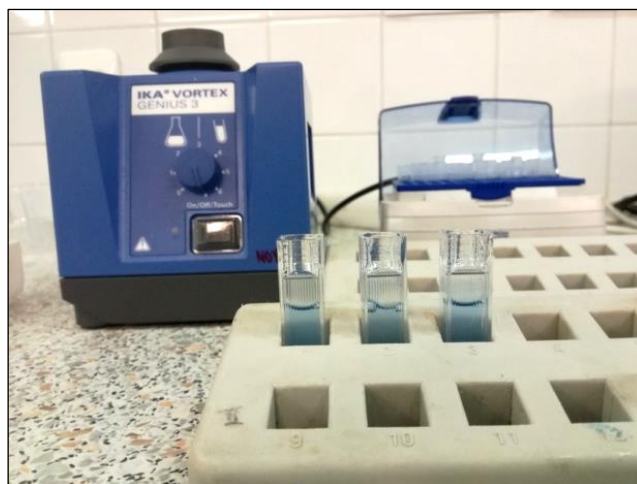
SLIKA 3.3. Određivanje koncentracije proteina spektrofotometrijskom metodom po Bradfordu
